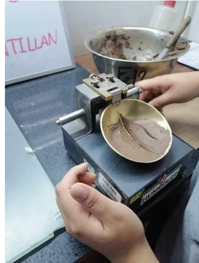
Figura 14. Ensayo de Límite Líquido Fuente: Elaboración propia
