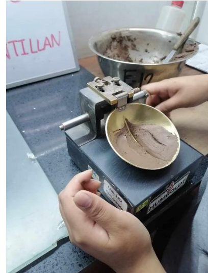
Figura 14. Ensayo de Límite Líquido Fuente: Elaboración propia
