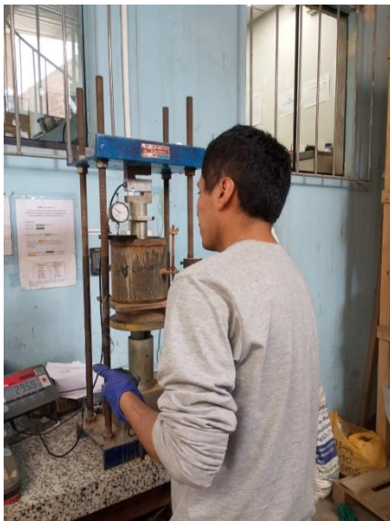
Figura 15. Ensayo de CBR Fuente: Elaboración propia
