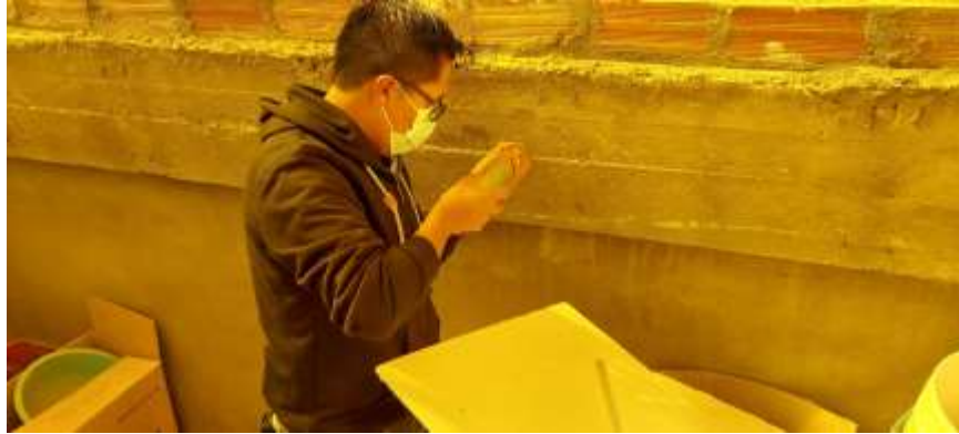
Imagen 2: prueba de resistencia con esclerómetro en viga secundaria
