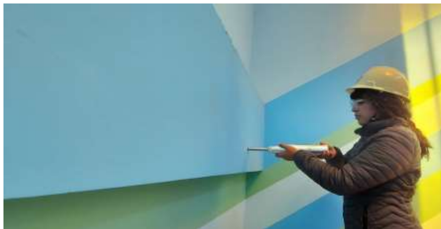
Imagen 3: prueba de resistencia con esclerómetro en vigas en escalera
