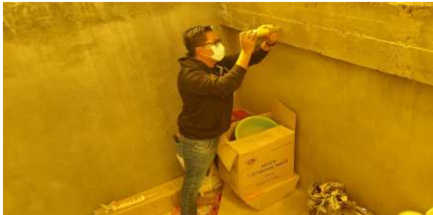
Imagen 3: prueba de resistencia con esclerómetro en vigas en escalera
