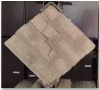
Figura 12. Falla por tensión diagonal en juntas (adobe-cal al 10%)
