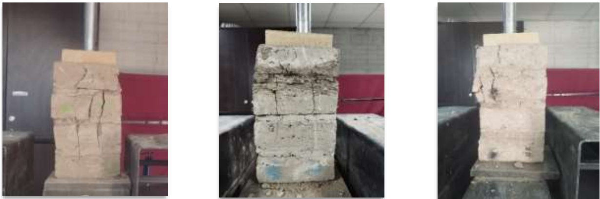
Figura. 10. Ensayo compresión en pilas adobe-Cal al 10%, 15% y 20% respectivamente.
