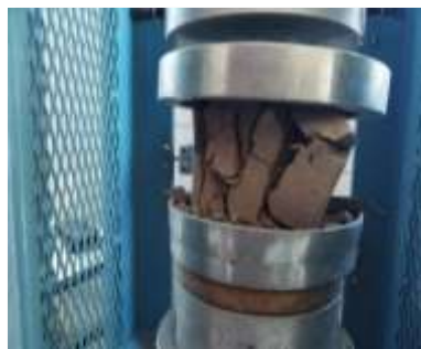
Figura. 6. Falla por aplastamiento (adobe-cal al 15%).
