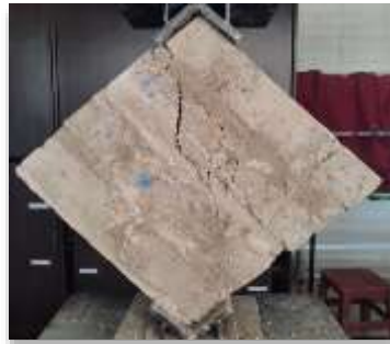
Figura. 13. Falla por deslizamiento (adobe-cal al 15%).
