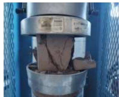
Figura. 7. Falla por corte (adobe-cal al 20%).
