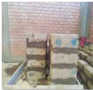
Figura. 3. Pilas de adobe-cal.
