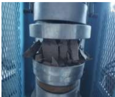
Figura. 5. Falla por aplastamiento (adobe-cal al 10%).
