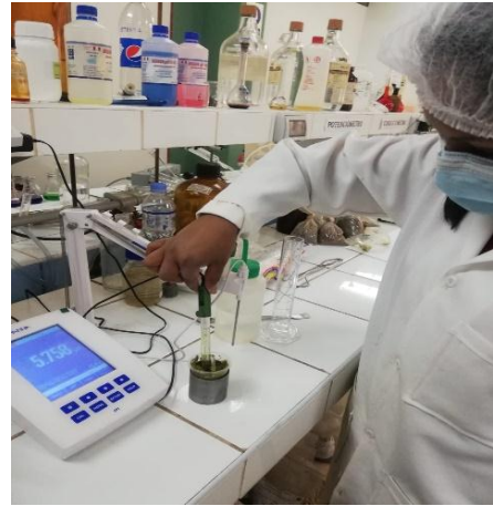
Fotografía 06: Determinación de PH de las muestras.
