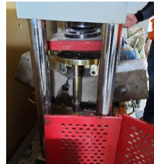
Fotografía 28: Viga a flexión con 7.5% de sustitución.
