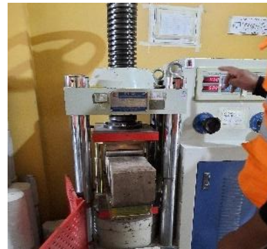
Fotografía 28: Viga a flexión con 7.5% de sustitución.
