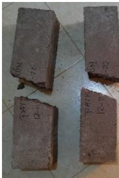
Fotografía 27: Vigas fracturadas - concreto patrón.
