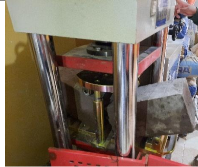
Fotografía 26: Rotura de viga.
