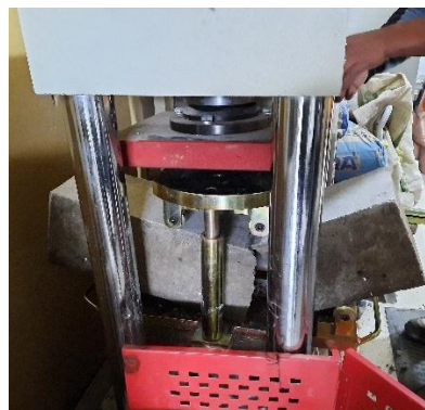
Fotografía 29: Viga fracturada con 15.0% de sustitución.
