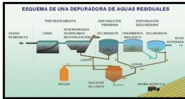
Figura 12. Esquema de una depuradora de aguas residuales
