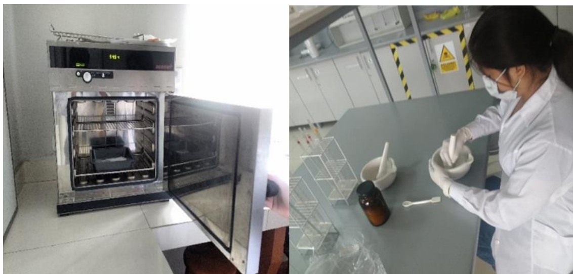
Anexo 2. Secado y molido de la Montmorillonita sódica.
