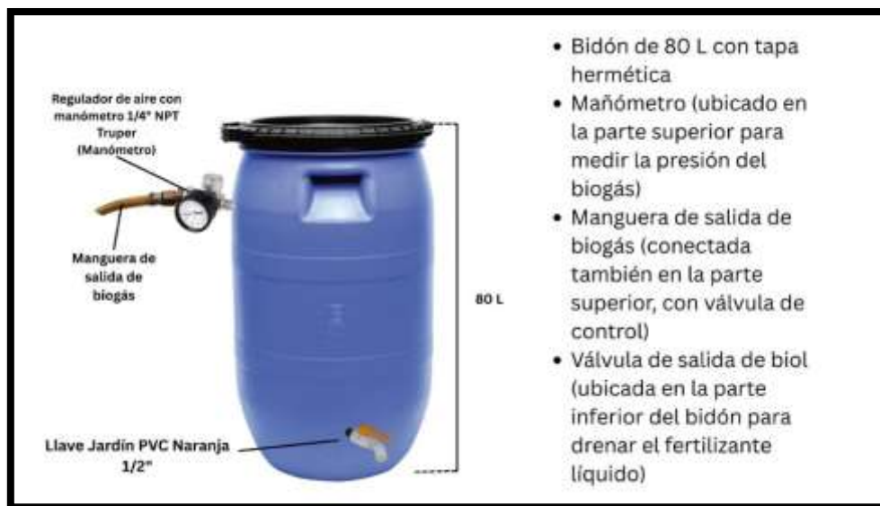
Figure 1. Homemade 80 L biodigester with inlet and outlet points. Figura 1. Biodigester artesanal de 80 L con puntos de entrada y salida.
