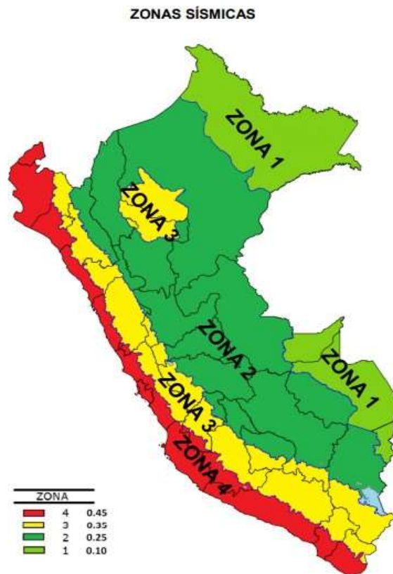
Figura 3: Mapa de zonas sísmicas del Perú Fuente: Norma E.030 Diseño Sismo resistente- 2017
