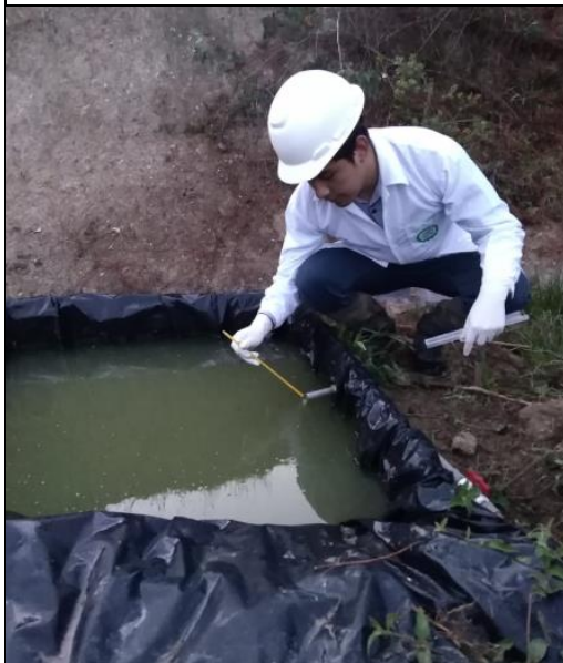
Foto 61. Toma de temperatura in situ
