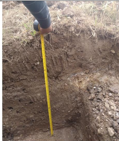
Foto 29. Medición de profundidad de laguna anaerobia igual a 80 cm.
