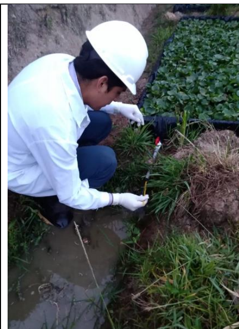
Foto 65. Toma de temperatura en el efluente
