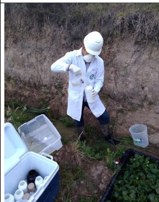
Foto 67. Muestreo parámetros fisicoquímicos y microbiológicos en el efluente
