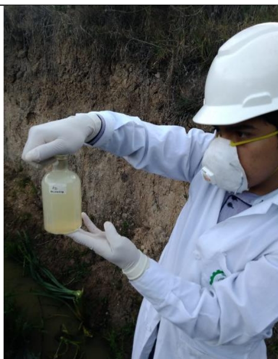
Foto 68. Muestreo de Oxígeno disuelto , el precipitado blanco ya nos indica la ausencia de oxígeno
