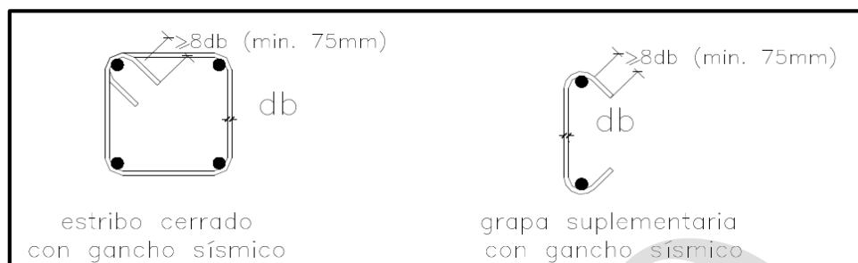
Figura 36. Ganchos sísmicos en estribos y garpas suplementarias
