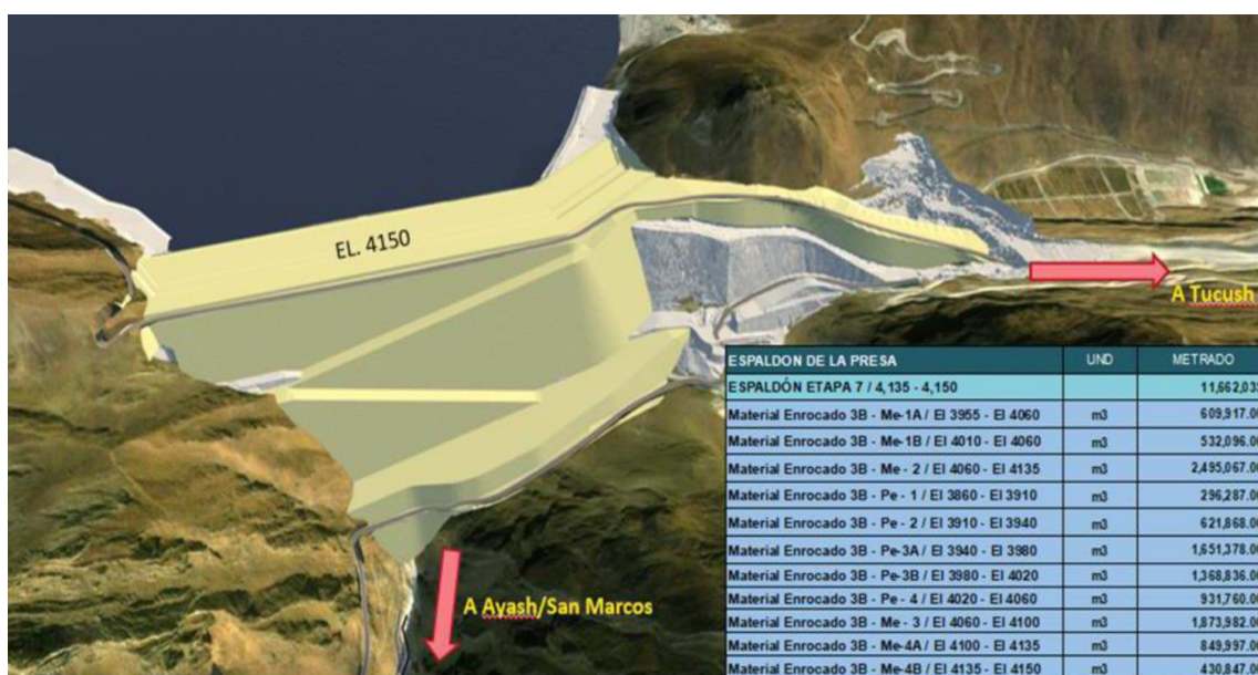
Figura 76: Etapas de relleno 3B en espaldón.
