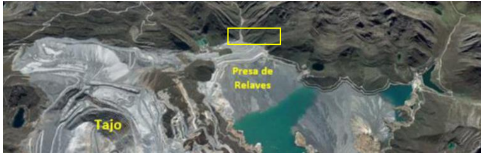
Figura 104: Ubicación de sistemas de Booster y Seepage.
