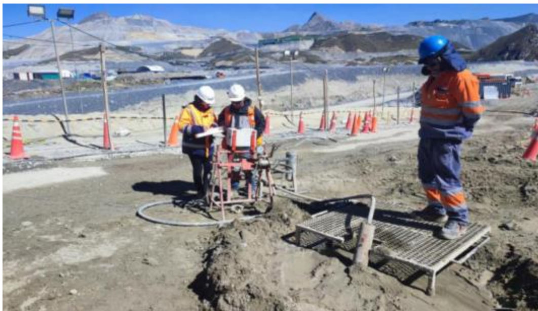
Figura 57: Proyecto 02; Ensayos de permeabilidad tipo Lefran-Carga constante.
