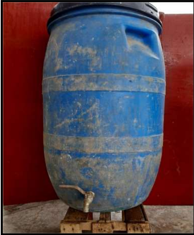
Imagen 25. Instalación biodigestor piloto - relación 1:3 Fuente: Elaboración propia, 2020.
