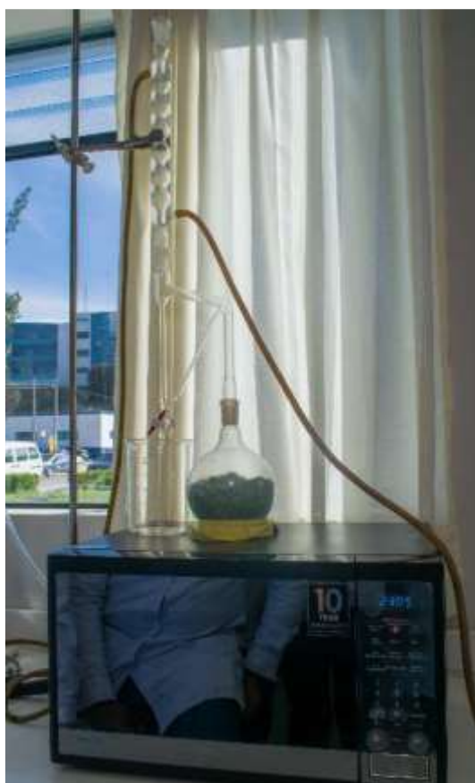
Figura 1. Adaptación de destilador Clevenger y microondas para Hidrodestilación.
