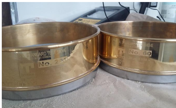
Fotografía 3. Tamices utilizados malla 250um.
