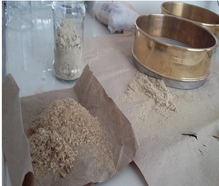
Fotografía 2. Las biomásas pasaron a ser tamizadas.
