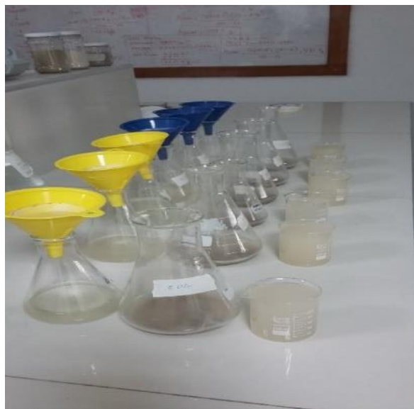
Fotografía 22. Filtración con tratamiento con Cebada.
