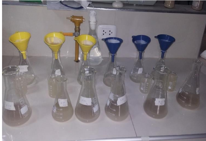
Fotografía 21. Filtración de tratamiento con Avena
