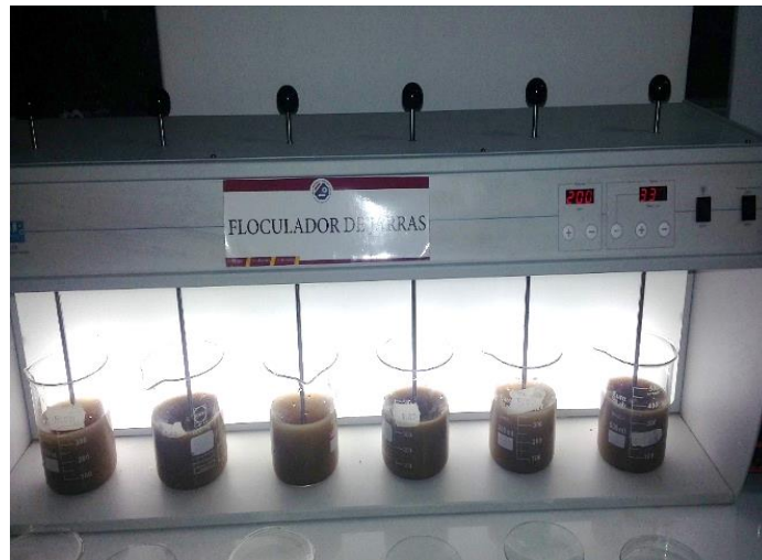
Fotografía 19. Uso de prueba de jarras para agitación- Avena.
