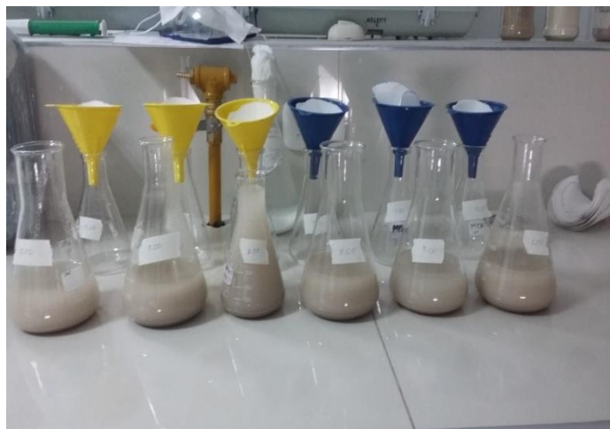
Fotografía 20. Sedimentación de la fase sólida.
