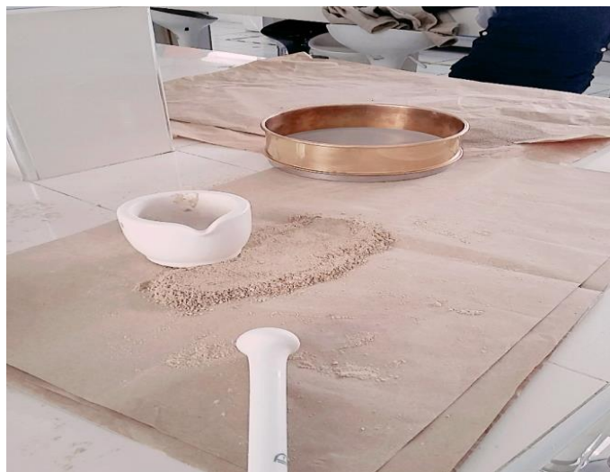
Fotografía 6. Biomasa activada molida y tamizada.
