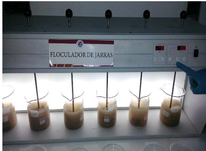
Fotografía 18. Uso de prueba de jarras para la agitación- Cebada.
