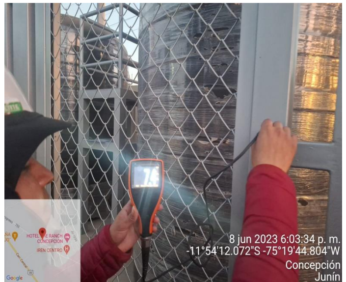
Figura 117: Realización de los protocolos de liberaciones y medición de espesor de pintura en estructuras metálicas.
