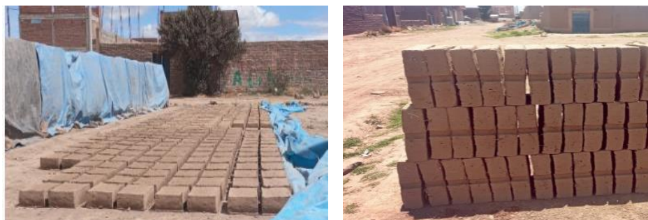
Figura 12. Secado de los moldes de adobe.
