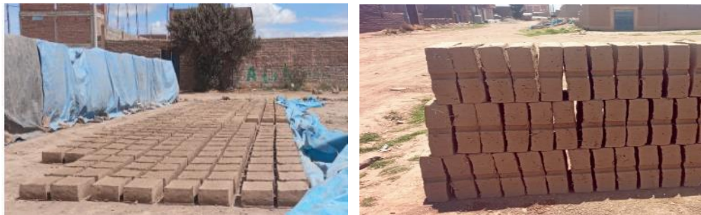
Figura 7. Secado de moldes de adobe
