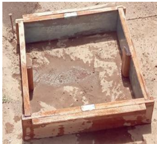
Figura 3. Molde de adobe para la elaboración de adobes.
