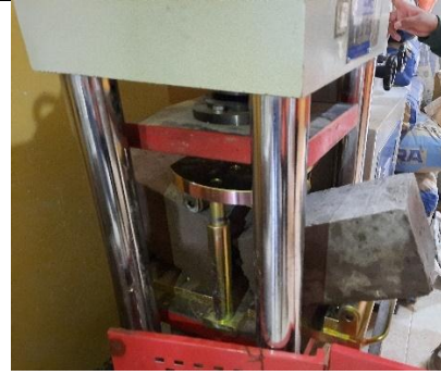
Fotografía 26: Rotura de viga.
