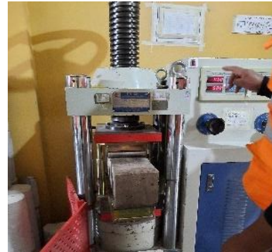
Fotografía 28: Viga a flexión con 7.5% de sustitución.
