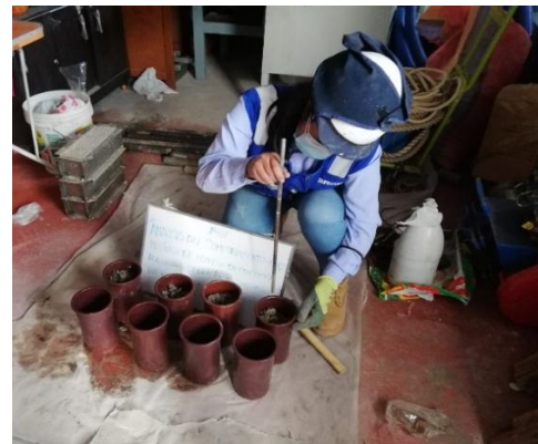
Fotografía 06: Determinación de PH de las muestras.
