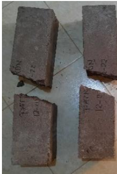
Fotografía 27: Vigas fracturadas - concreto patrón.
