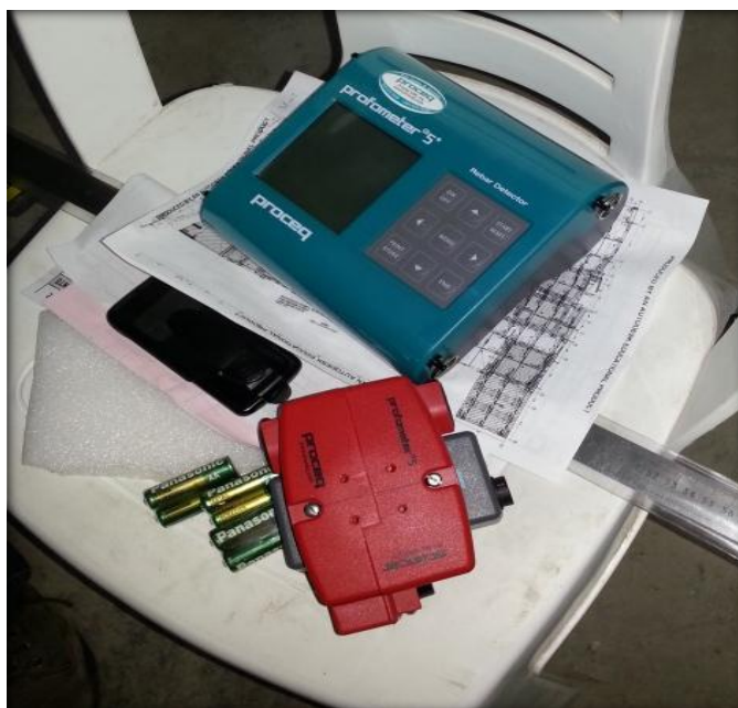
Figura 25 - Equipo utilizado para detectar acero
