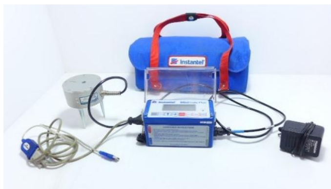
Figura 15 – Equipo de ensayos de microtrepidaciones (IGR 2013)
