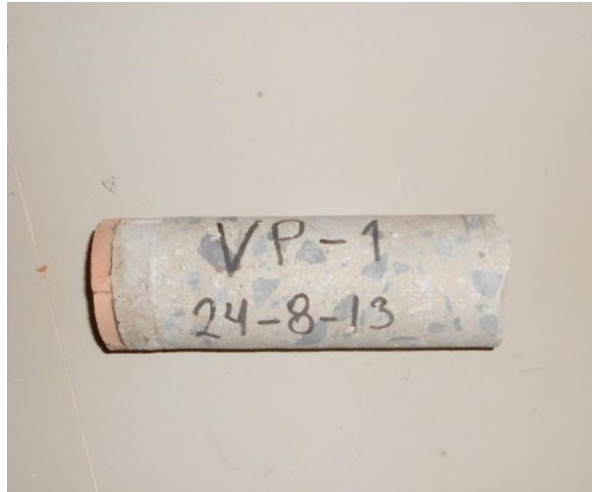
Figura 47 - Vista de un testigo del primer piso en el cual se aprecia el revestimiento
