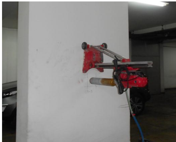
Figura 24 - Equipo utilizado para la extracción de muestras de concreto
