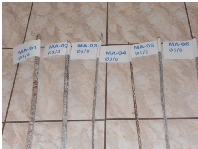
Figura 28 – Codificación de muestras de acero
