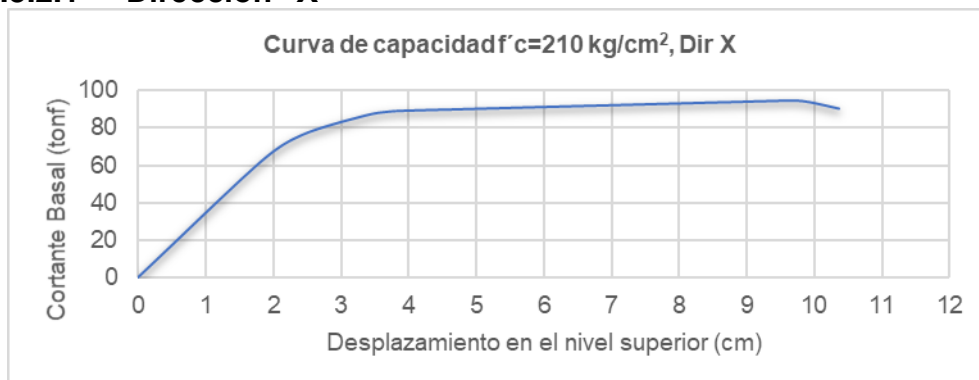
Figura 27. Curva de capacidad, f'c = 210 \text{ kg/cm}^2 , Dir X. Fuente: Elaboración propia.
