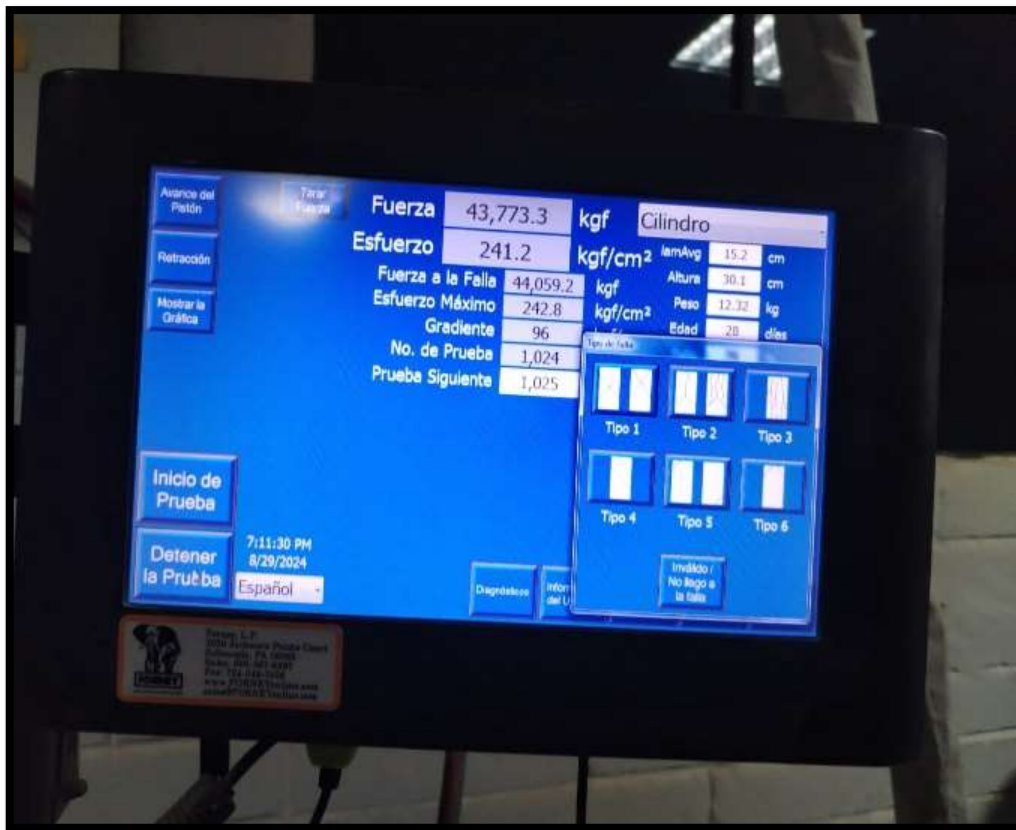
Ensayo de compresión de probetas a los 28 días.
