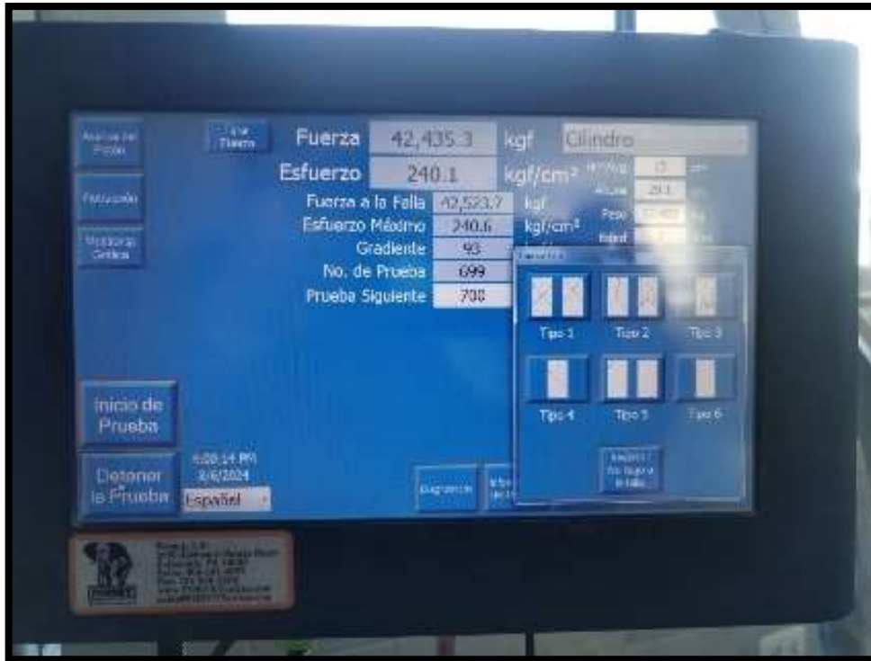
Ensayo de compresión de probetas a los 7 días.
