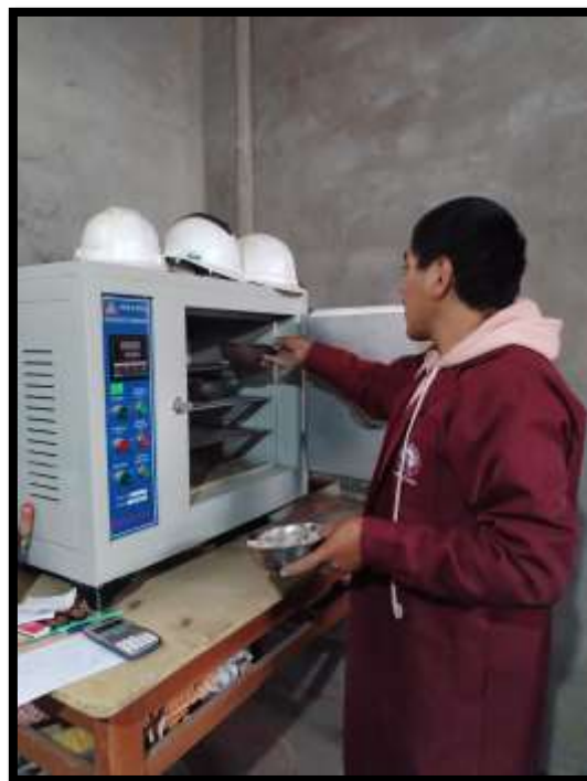
Ensayo de contenido de humedad de agregado grueso y fino.
