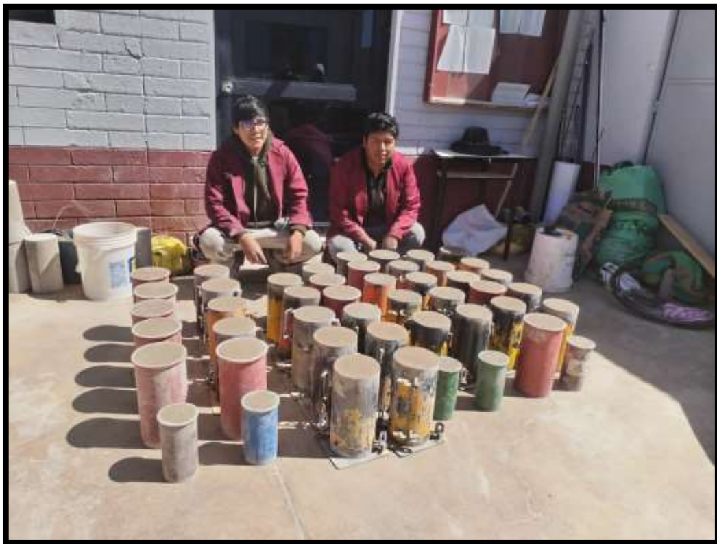
Elaboración de probetas o briquetas cilíndricas.
