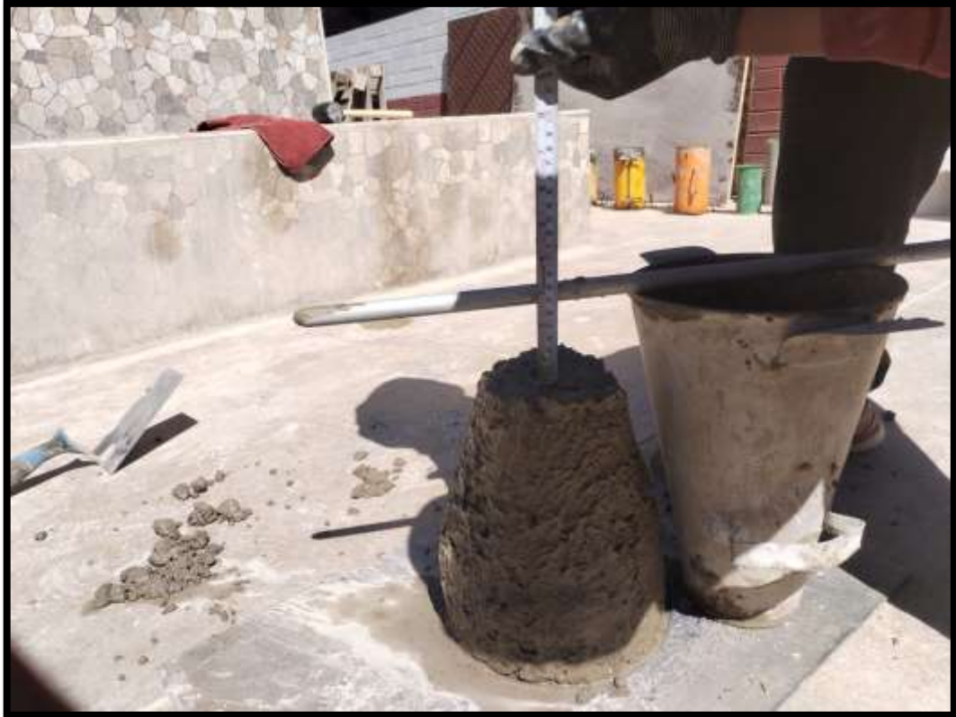
Ensayo de slump en diferentes proporciones incorporados con nanosílice y polvillo de horno rotax.
