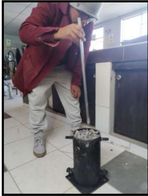
Peso unitario compactado de agregado grueso.
