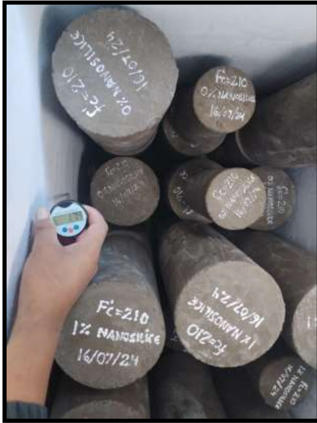
Curado de probetas sometidos en congelación -5^{\circ}\text{C} .
