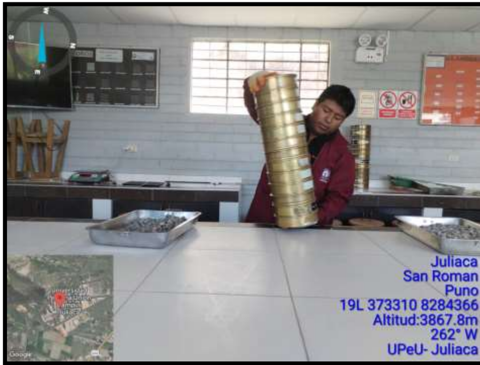
Ensayo de granulometría de agregado grueso
