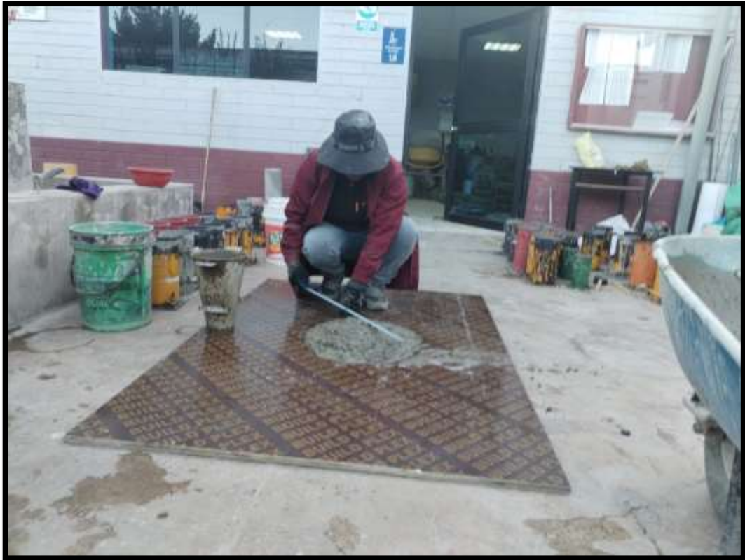
Ensayo de slump con mayor incorporación de nanosilice.
