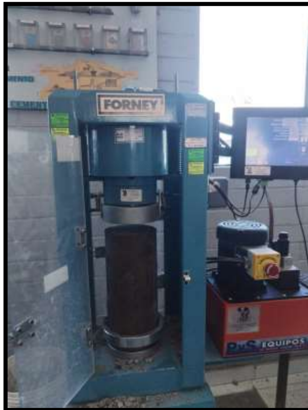
Ensayo de compresión a los 7, 14 y 28 días en el laboratorio de la UPeU.
