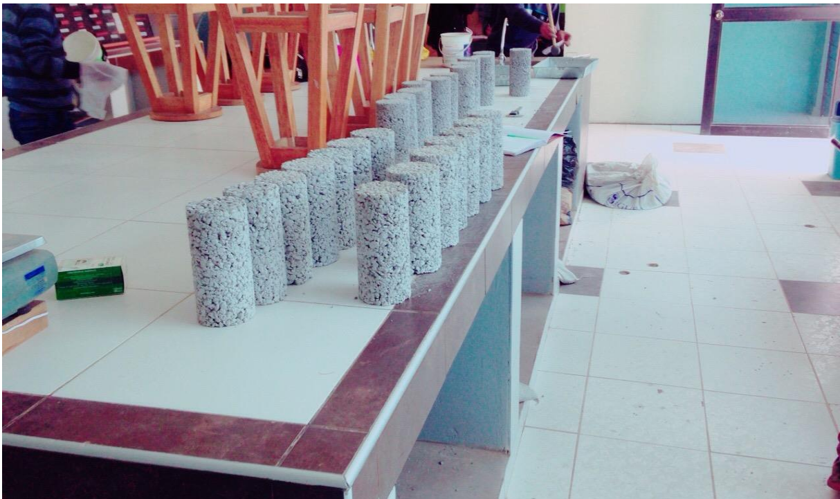
Fotografía 16. Especímenes previo al ensayo de resistencia a compresión
