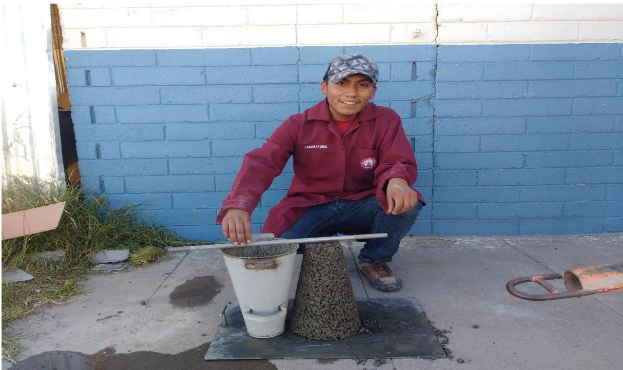
Fotografía 10. Ensayo de asentamiento del concreto permeable
