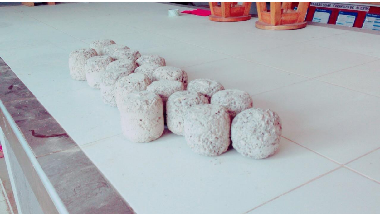
Fotografía 18. Especímenes después del ensayo de resistencia al desgaste de abrasión e impacto
