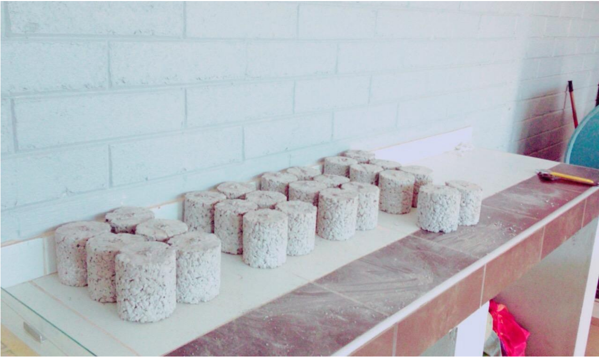
Fotografía 17. Especímenes previo al ensayo de resistencia la desgaste por abrasión e impacto
