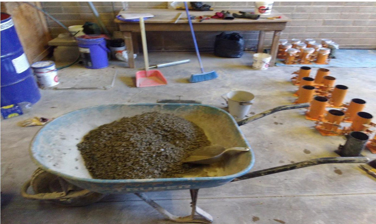
Fotografía 22. Mezcla de concreto permeable
