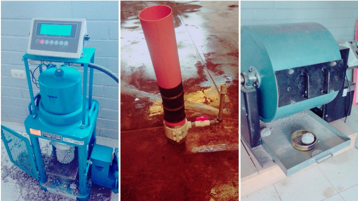
Fotografía 13. Equipos para resistencia a la compresión, permeabilidad y desgaste de abrasión e impacto
