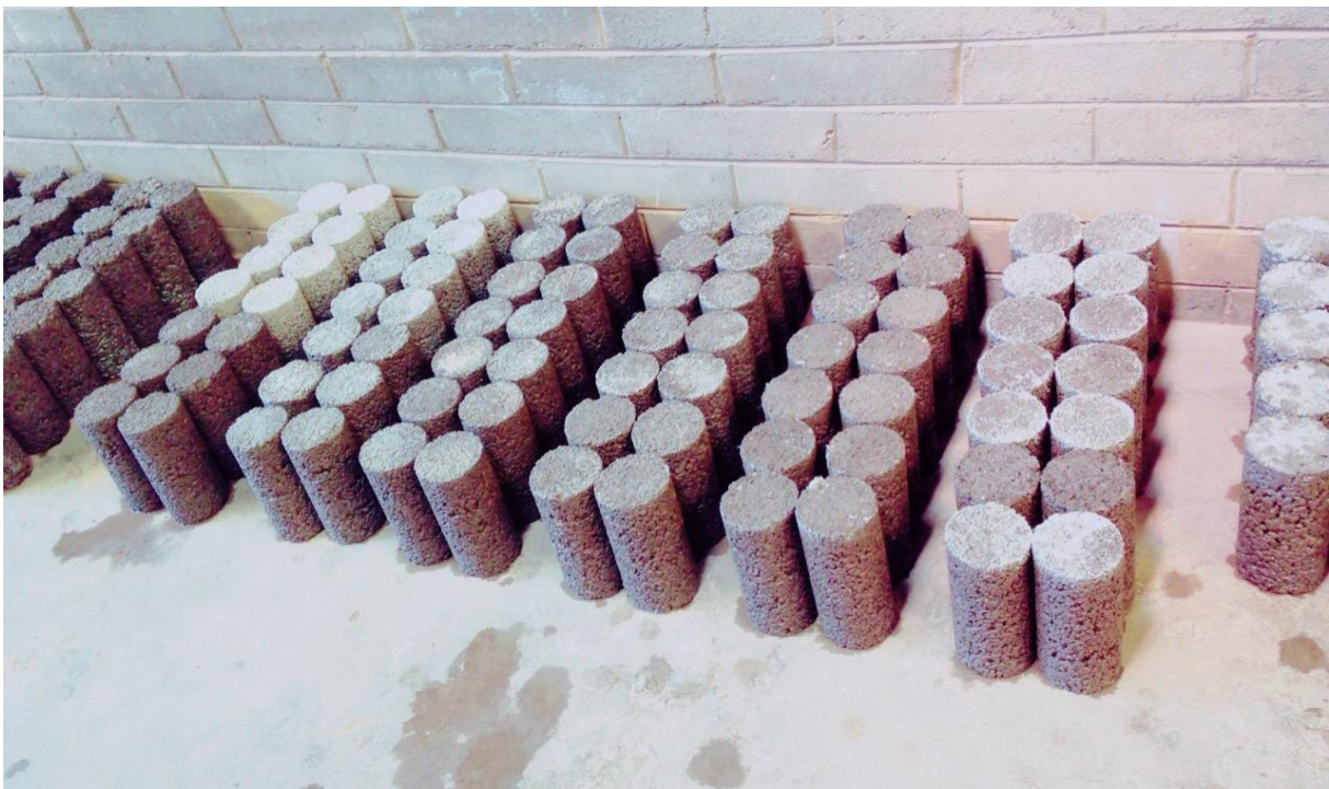
Fotografía 14. Especímenes de concreto permeable separadas por diseño de mezcla
