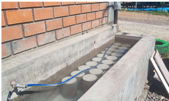
Figura 3 Curado de probetas de concreto
