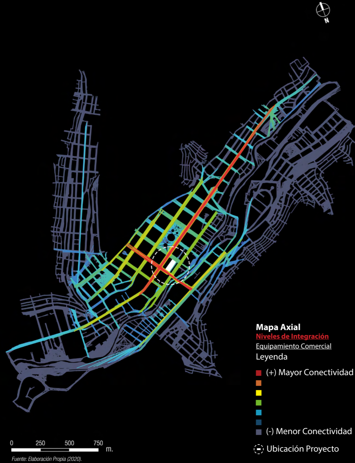
Figura 58. Mapa Axial, niveles de Integración para el área del Equipamiento Comercial, radio 1500 metros.
