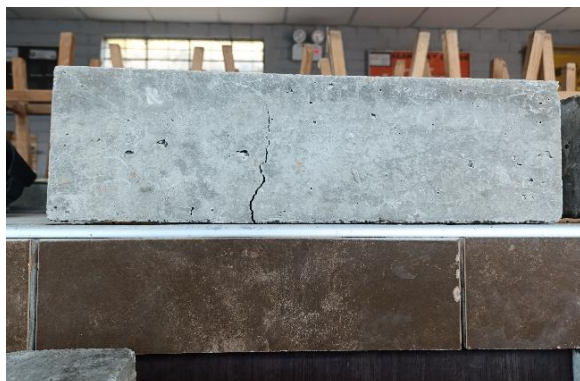
Figura 7: Probeta de concreto ensayada a flexión
