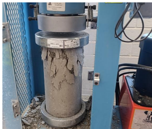
Figura 5: Ensayo de resistencia a compresión en probetas reforzadas con FA y MFC
