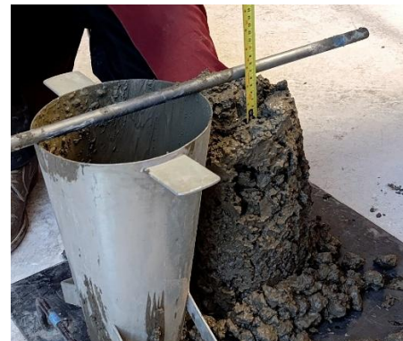
Figura 4: Control de Asentamiento (Slump)
