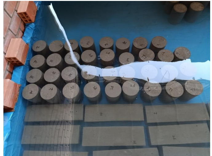
Figura 3: Curado de muestras de concreto según norma ASTM C511
