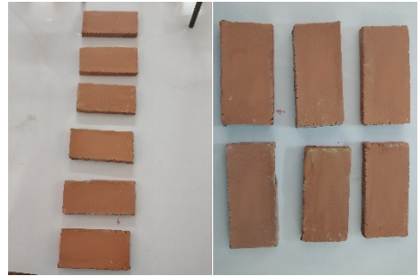
Figura 9. Muestras de ladrillo cocido
