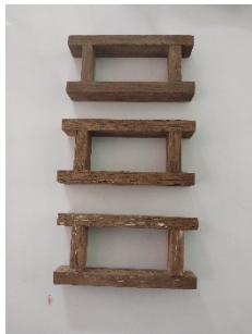
Figura 7. moldes para elaborar las muestras de ladrillo
