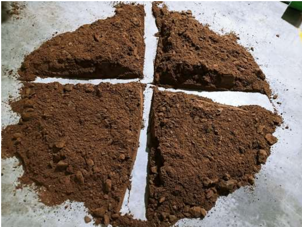
Figura 15. Cuarteo para obtención de muestra representativa.
