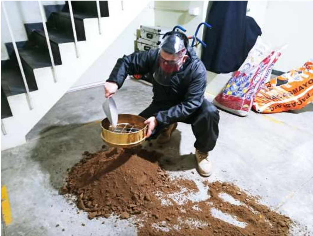
Figura 13. Tamizado 2.5" de muestra ladera de cerro.
