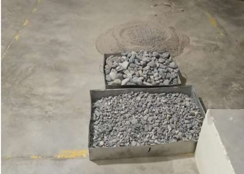
Figura 19. Después del tamizado 1", se procede a seleccionar la muestra para peso y conteo.
