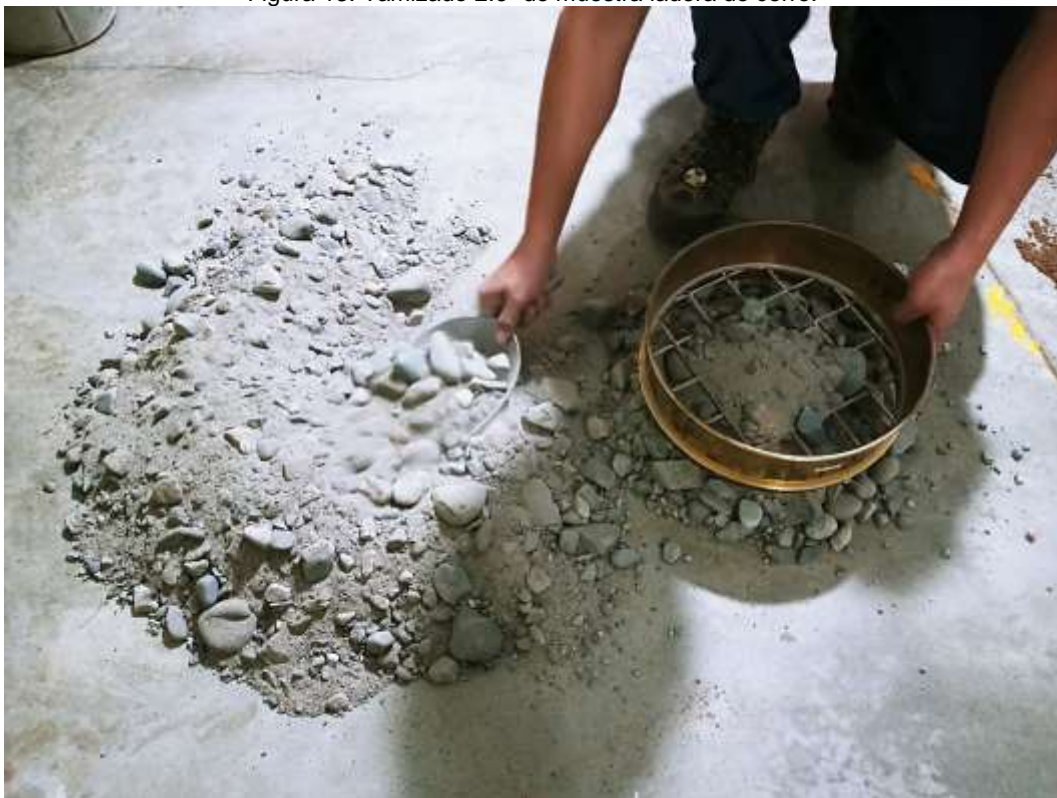
Figura 13. Tamizado 2.5" de muestra ladera de cerro.
