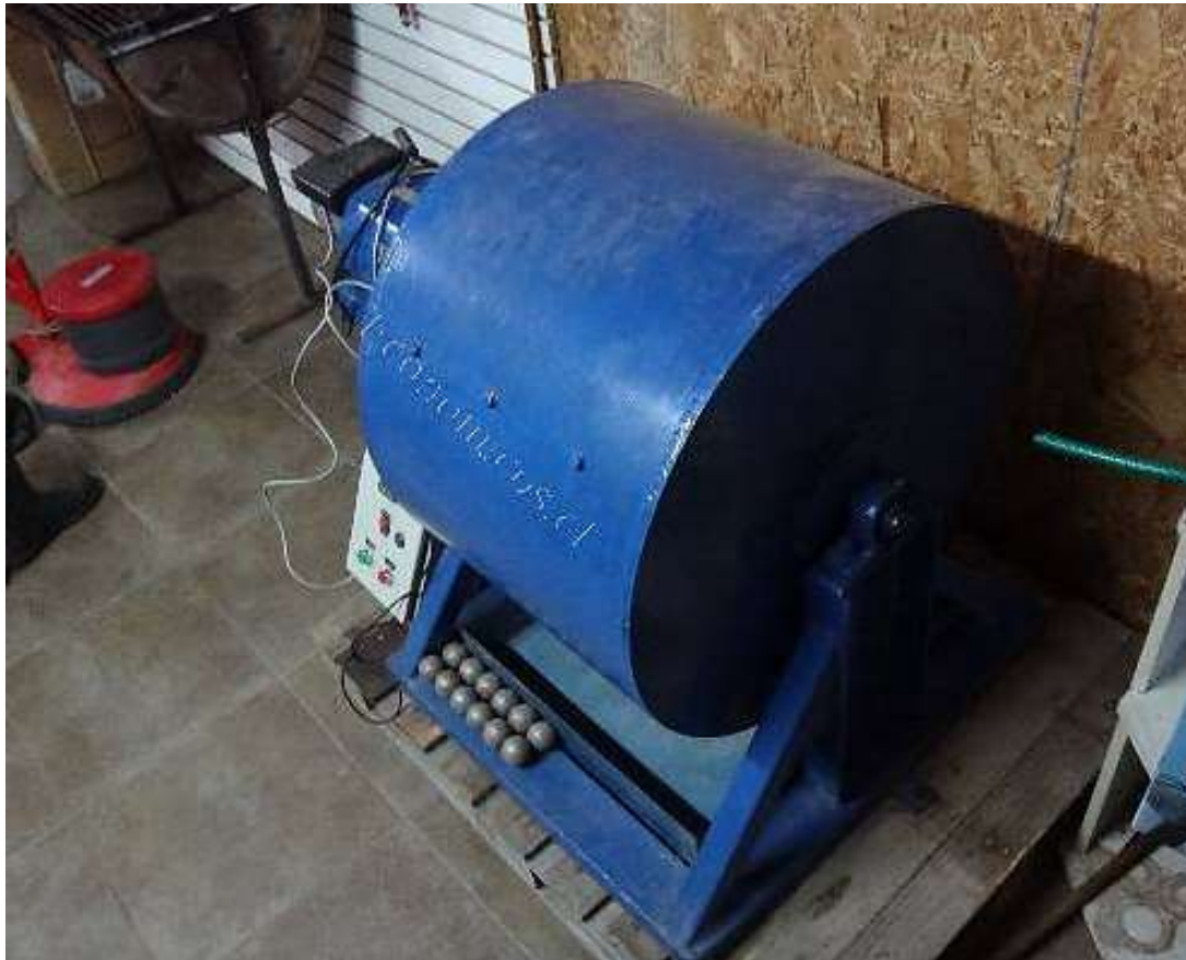
Figura 22. Máquina de trituración los Ángeles.
