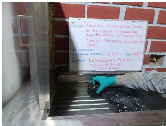
Ilustración 6. Baño maría para briquetas de 5.5%
