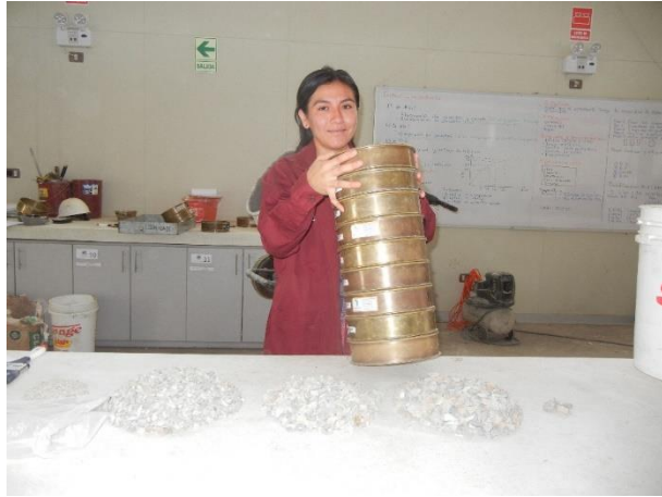
Figura 25. Ensayo de análisis granulométrico del agregado fino.
