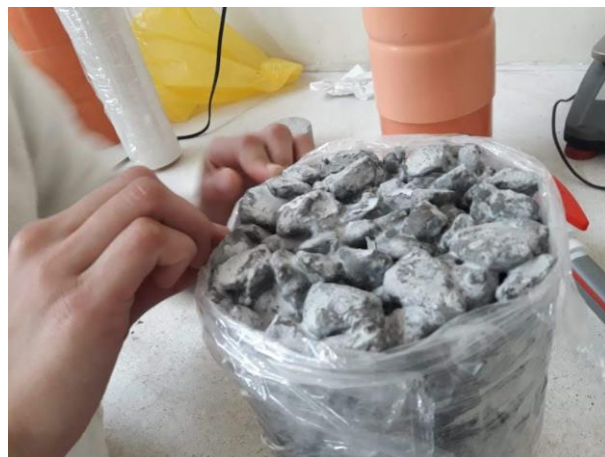
Figura 45. Probeta envuelta en latex para realizar el ensayo de permeabilidad.
