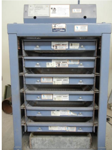
Figura 28. Máquina para realizar el ensayo de análisis granulométrico del agregado grueso (Huso 7).
