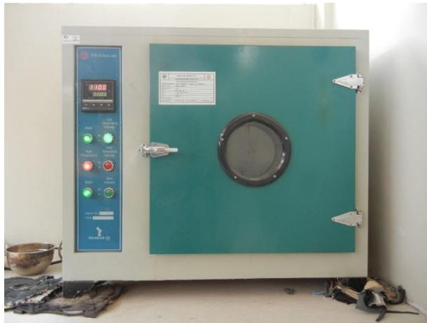
Figura 32. Horno usado para los ensayos de caracterización de los agregados.
