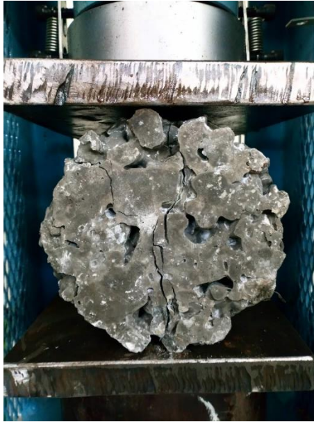
Figura 43. Ensayo de resistencia a la tracción indirecta del concreto permeable.
