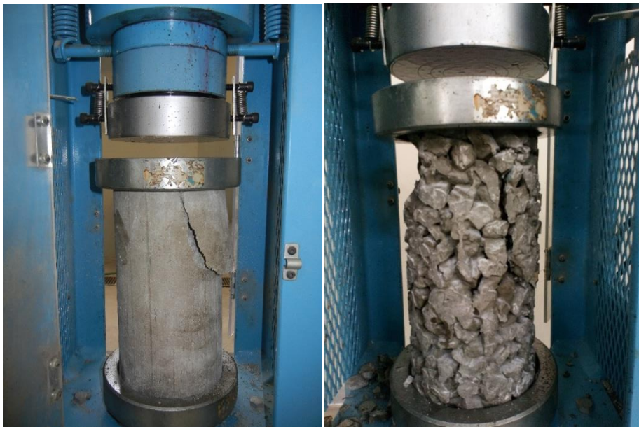
Figura 42. Resistencia a la compresión del concreto convencional y concreto permeable.
