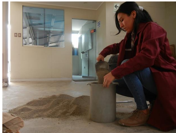
Figura 29. Ensayo de peso unitario suelto del agregado fino.
