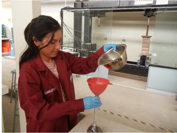
Figura 31. Ensayo de peso específico del agregado fino.
