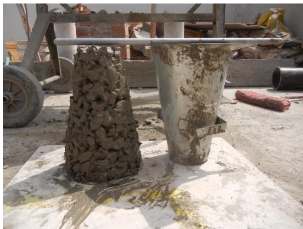
Figura 39. Asentamiento del concreto permeable.
