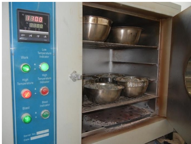
Figura 33. Muestras para los ensayos de contenido de humedad y peso específico.
