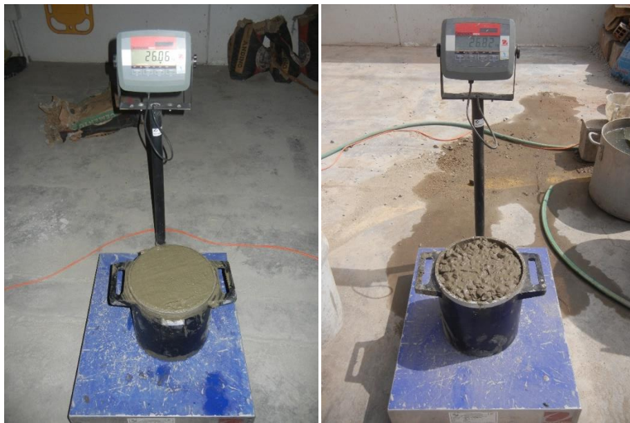
Figura 38. Ensayo de peso unitario del concreto convencional y concreto permeable.
