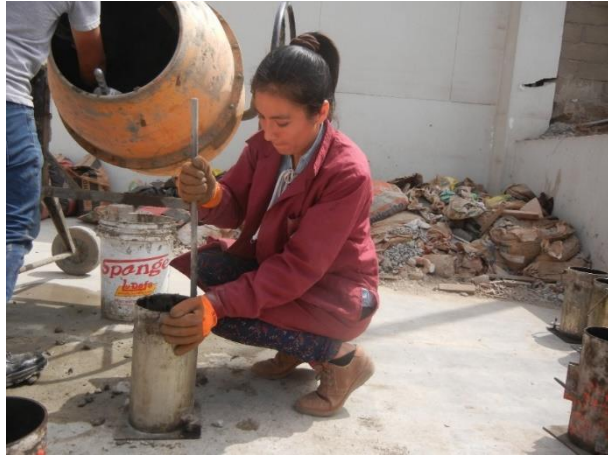
Figura 40. Moldeo de la mezcla de concreto.
