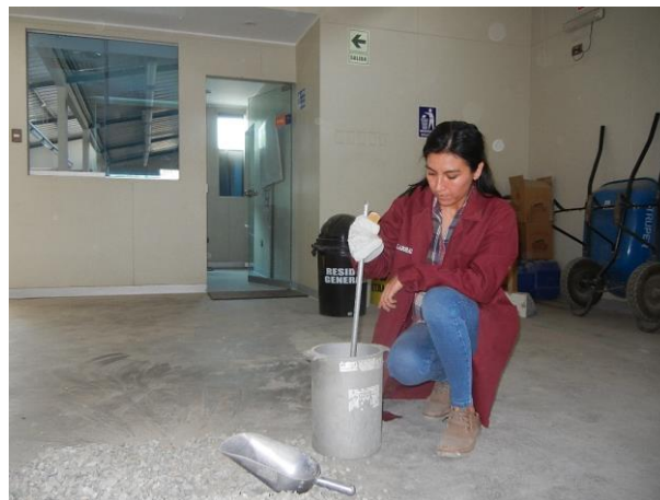
Figura 30. Ensayo de peso unitario compactado del agregado grueso.
