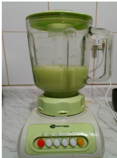
Figura 36. Licuado de las pencas de nopal y obtención del mucílago.
