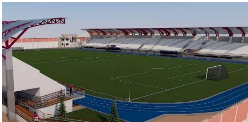
Fig. 9. Modelo 3D detallado del estadio municipal Publio Castro creado con Tekla Structures.
