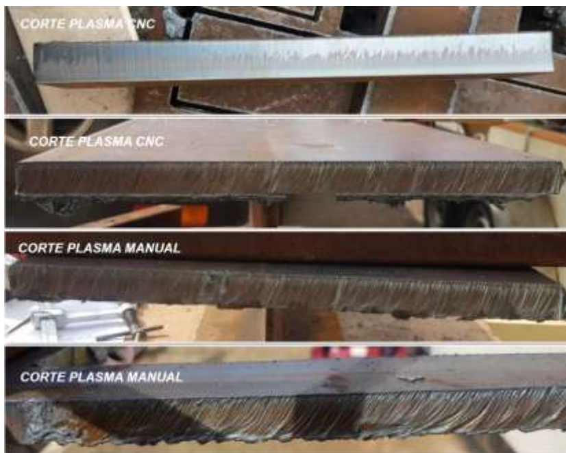
Fig. 12. Comparación del borde de una pieza cortada con plasma CNC y plasma manual. Se observa la suavidad y uniformidad del borde en plasma CNC en contraste con algunas irregularidades en el plasma manual.
