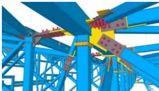
Fig. 2. Ejemplo de modelo 3D generado con tekla structures, este modelo incluye información detallada sobre dimensiones, geometría y propiedades de los materiales, lo que facilita la planificación precisa de la fabricación y el montaje.
