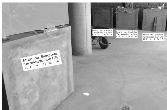
FIGURA 3. Muros tarrajados con el mortero mejorado.
