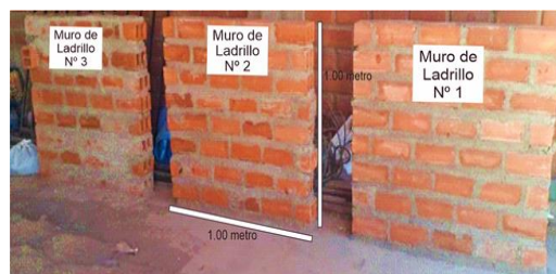
FIGURA 1. Muros de ladrillo N.º 1, N.º 2 y N.º 3 con dimensiones de 1mx1m.
