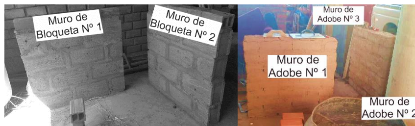
FIGURA 2. Muros de ladrillo N.º 1, N.º 2 y N.º 3 con dimensiones de 1mx1m.
