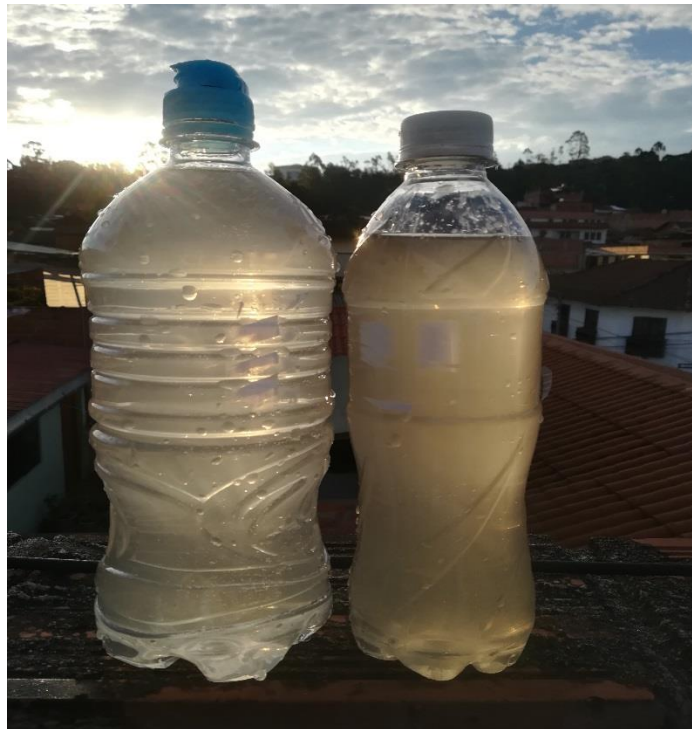
Figura 56. Resultado visual del agua después del tratamiento mediante el método del Lombrifiltro (botella izquierda es con la especie Eisenia foetida - botella derecha con la especie Lumbricus terrestris )
