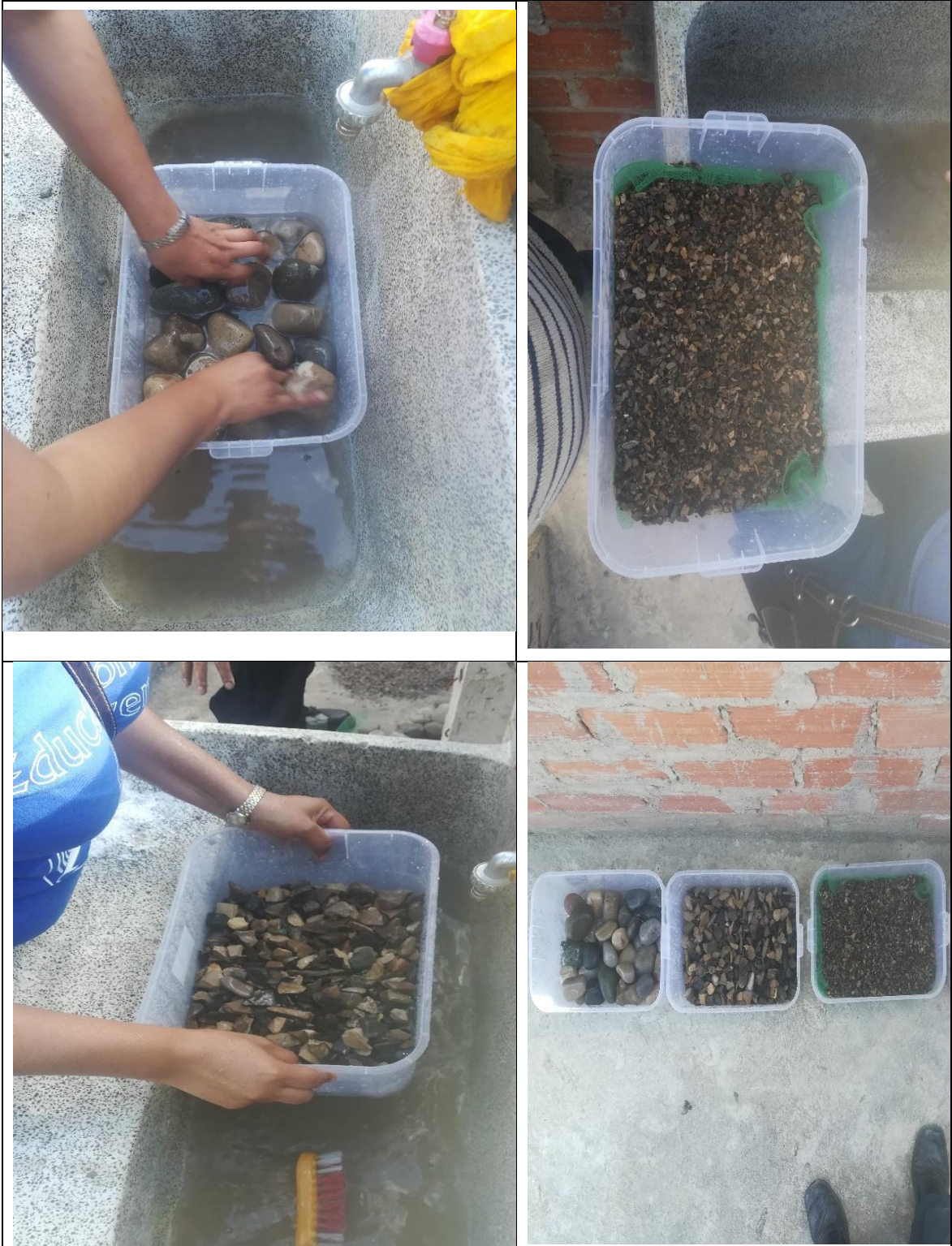
Figura 45. Capas del tratamiento mediante el lombrifiltro
