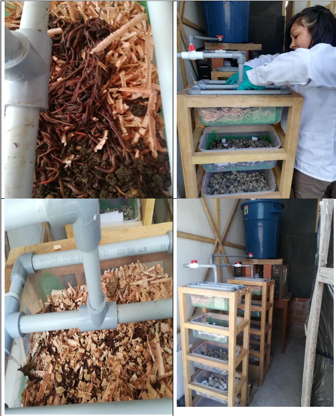
Figura 49. Puesta en marcha del tratamiento mediante lombrifiltro
