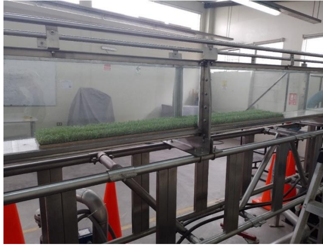
Figura 16 Instalación de base de grass sintético en canal de pendiente variable (Fuente: Elaboración propia)
