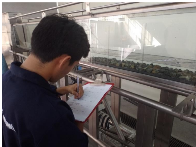
Figura 18 Toma de tirantes de agua para piedra chancada (Fuente: Elaboración propia)
