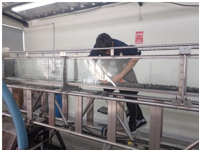
Figura 15 Instalación de base de canto rodado en canal de pendiente variable (Fuente: Elaboración propia)
