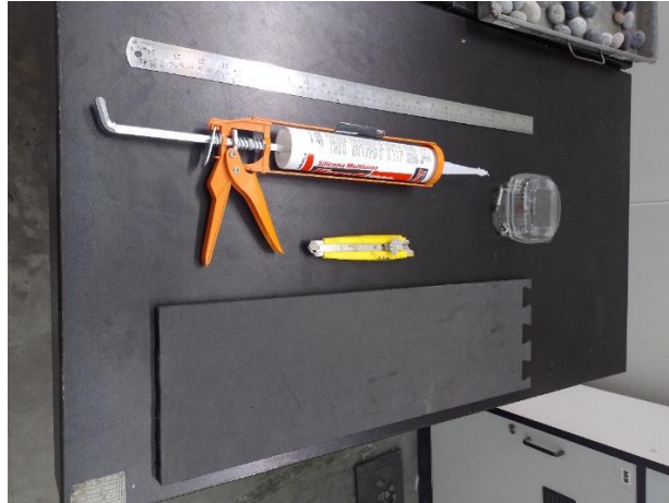
Figura 11 Materiales utilizados: Pistola de silicona, regla, microporoso y cúter (Fuente: Elaboración propia)
