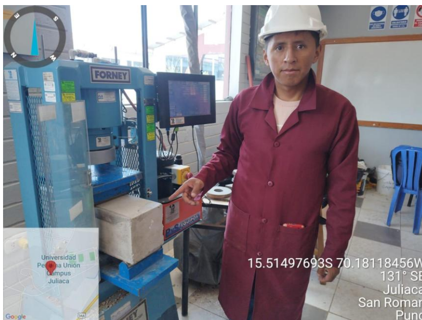
Figura 10. Ensayo de resistencia a la rotura transversal a los 14 y 28 días
