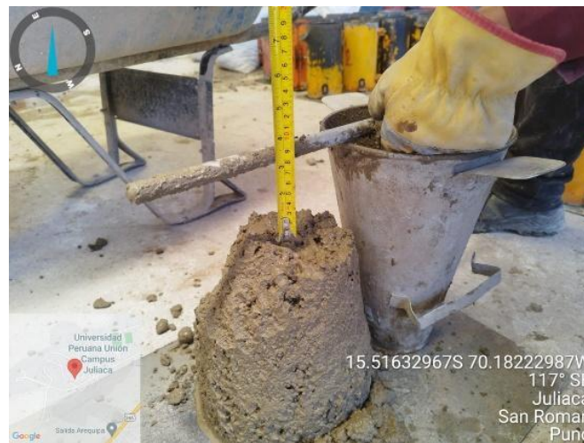
Figura 3. Asentamiento en pulgadas ceniza de mazorca – Sustitución
