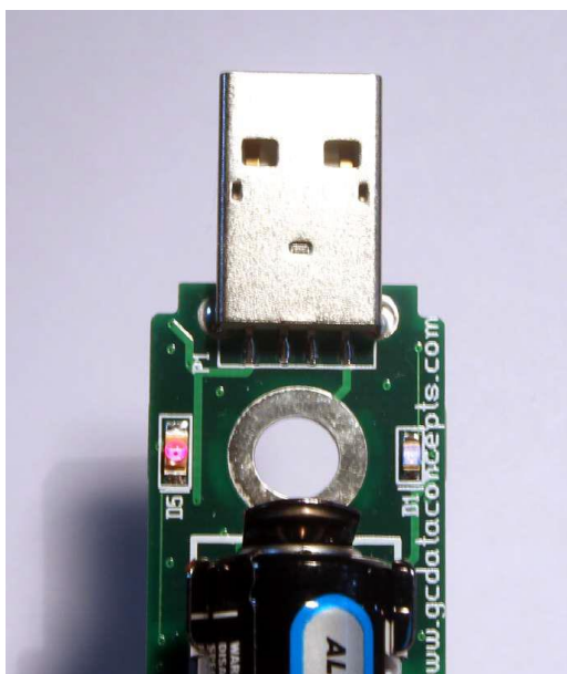
Figura 13: Indicadores LED de estado
