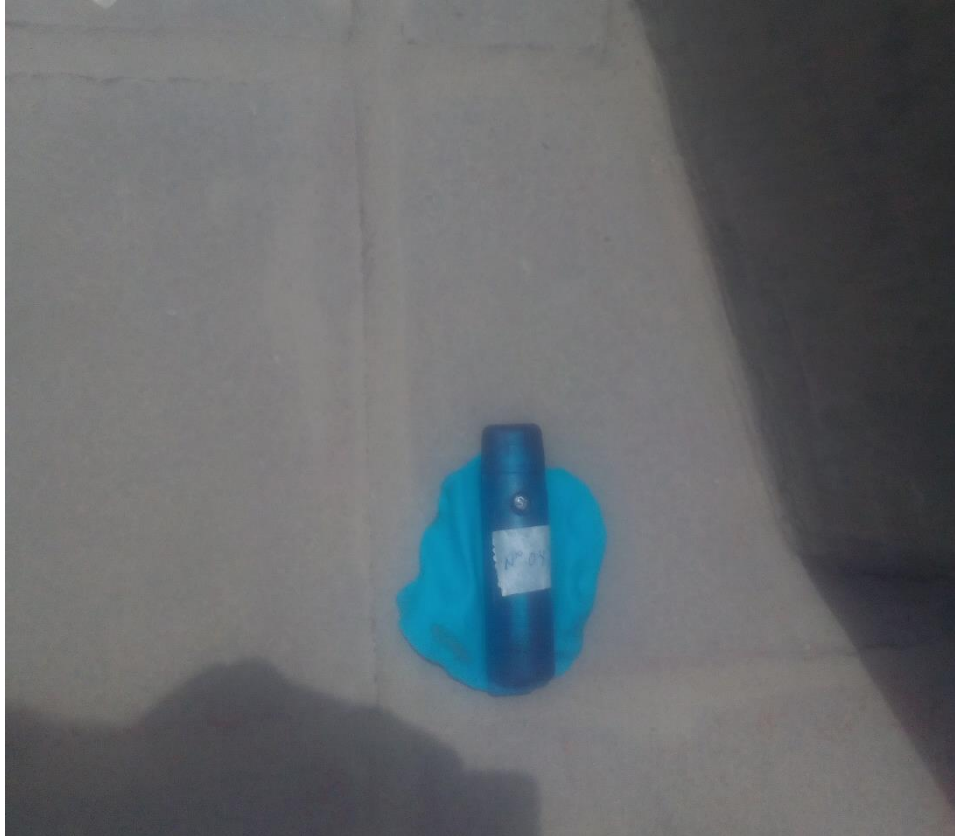
Figura 3. 34 - Colocación del acelerómetro 04
