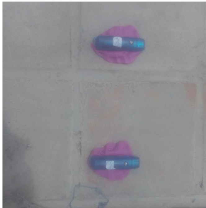
Figura 3. 15 - Colocación del Acelerómetro 01 y 02
