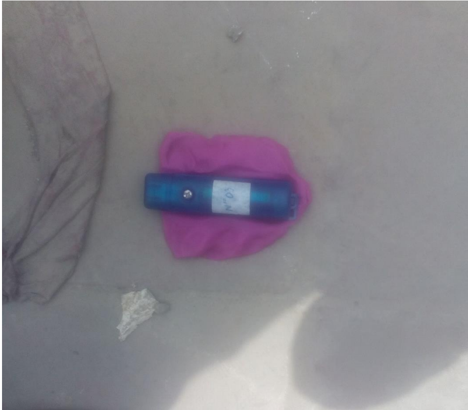
Figura 3. 30 – Colocación del acelerómetro 03
