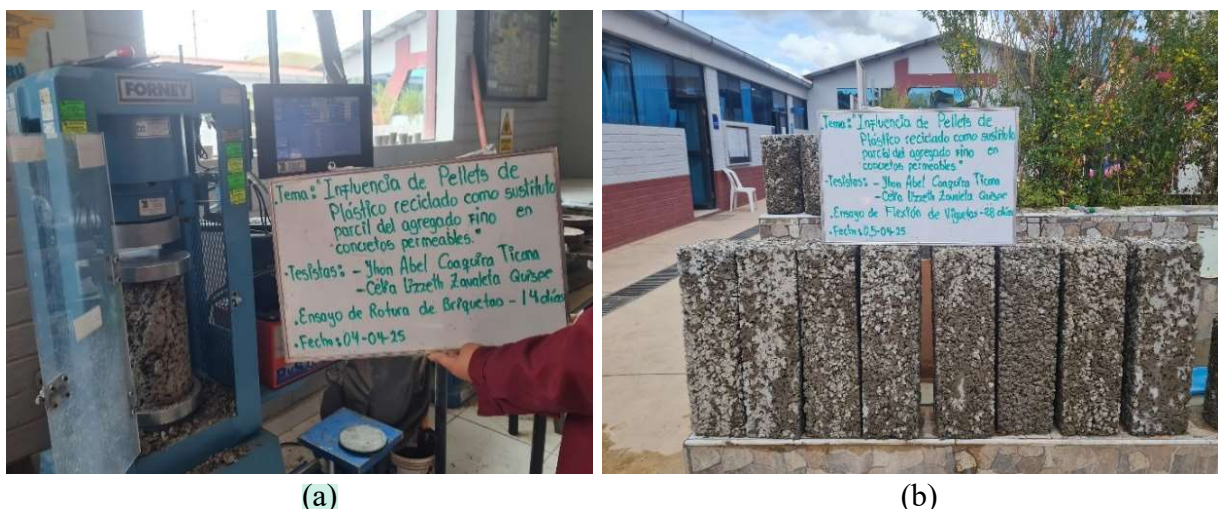
Figura 7. (a) Ensayo de compresión y (b) espécimen utilizado para la prueba de flexión.
