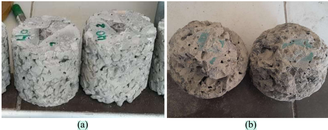
Figura 9. (a) Concreto permeable antes de someter al ensayo de abrasión. (b) Después de someterlas al ensayo de abrasión.
