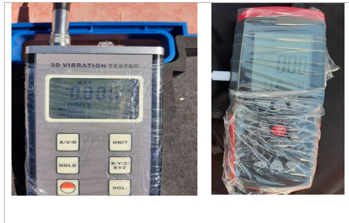
Figura 5. Equipos para monitoreo de desplazamiento y de viento
