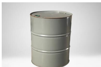
Figura 9. Cilindro para determinar la densidad los residuos sólidos.
