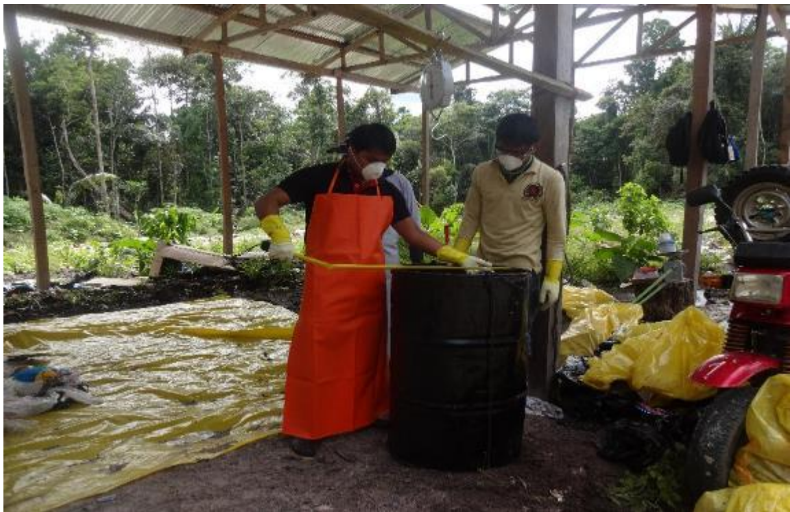
Figura 76. Registro de pesos y altura libre de cilindro para determinación de la densidad.
