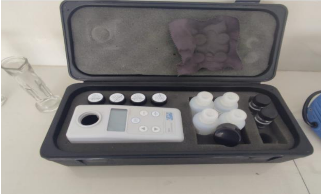
Anexo 5.5 Turbidímetro portátil VELP Scientifica TB1
