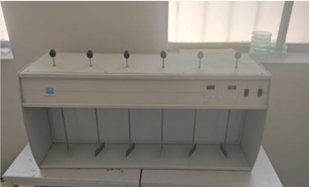
Anexo 5.2 Test de jarras marca VELP Scientifica modelo JLT6 Serie 35387
