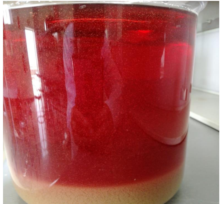
Anexo 12: Coagulación del agua de camal después de la solución de moringa.
