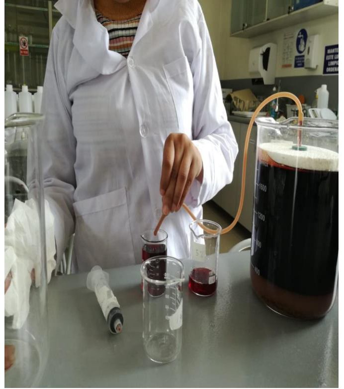
Anexo 12: Coagulación del agua de camal después de la solución de moringa.
