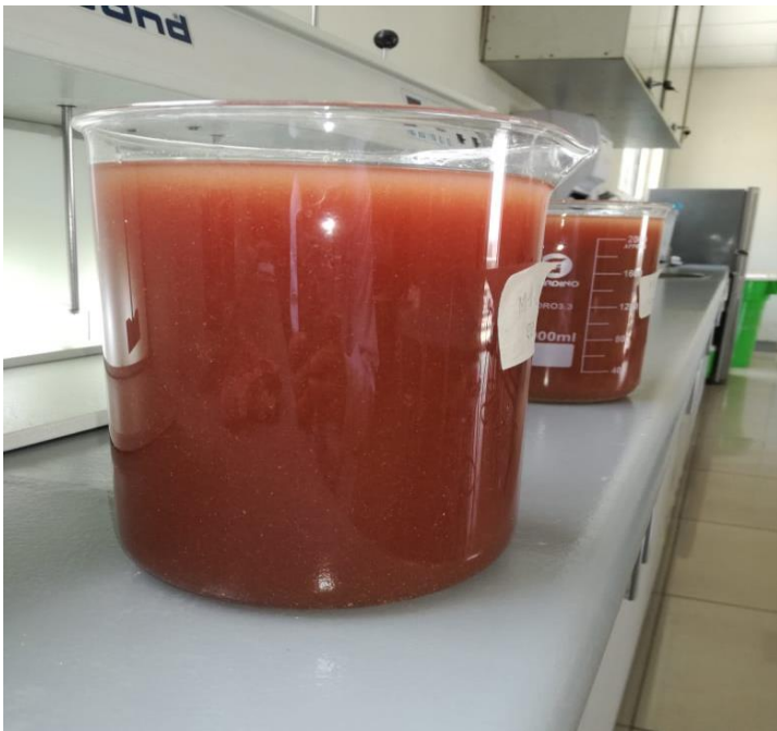
Anexo 12: Coagulación del agua de camal después de la solución de moringa.
