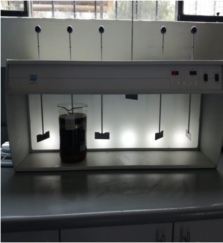
Anexo 12: Coagulación del agua de camal después de la solución de moringa.
