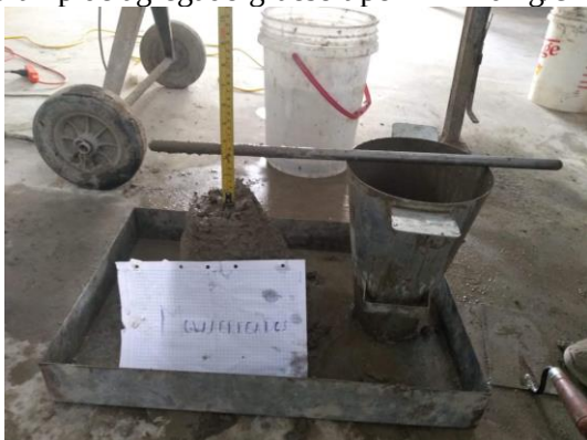
Slump de agregado grueso tipo TC 210 kg/cm 2
