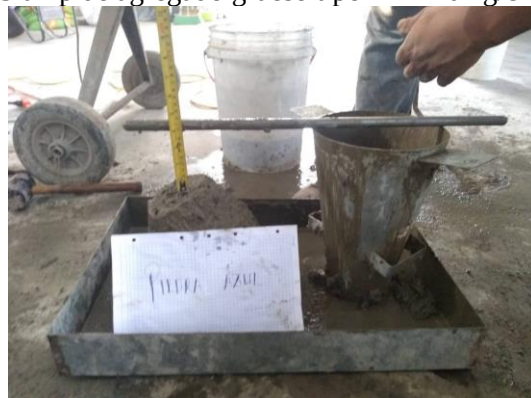
Slump de agregado grueso tipo A 210 kg/cm 2
