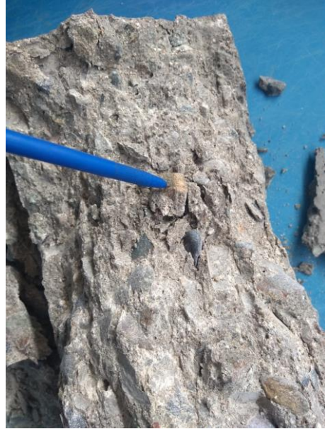
Mezcla de agregados angulares y redondeado con alteraciones como consecuencia menor adeherencia AG tipo AR
