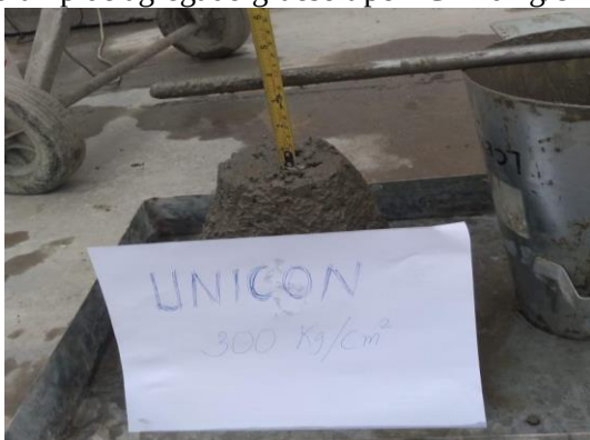
Slump de agregado grueso tipo AR 300 kg/cm 2
