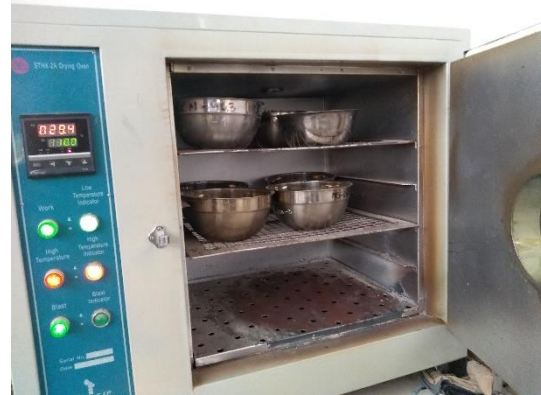
Puesta de muestra en horno para contenido de humedad
