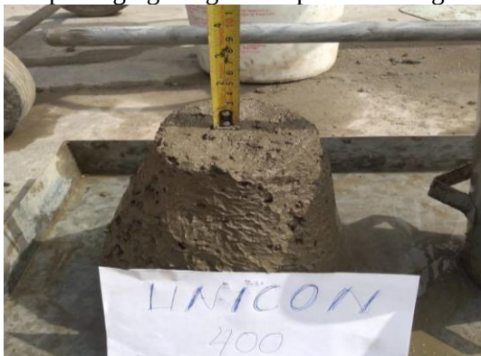
Slump de agregado grueso tipo TC 300 kg/cm 2
