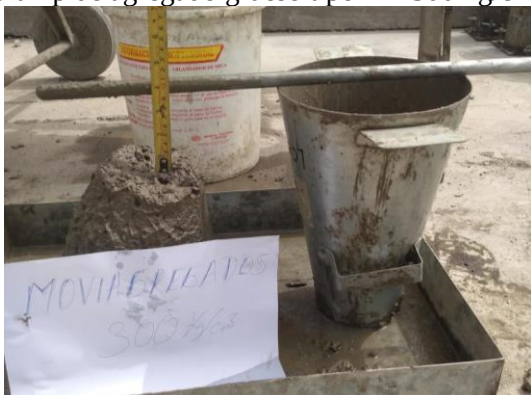
Slump de agregado grueso tipo TC 300 kg/cm 2
