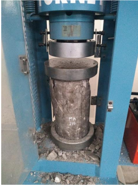
Rotura briqueta 7 días, AG tipo TC y resistencia 180.96 kg/cm 2
