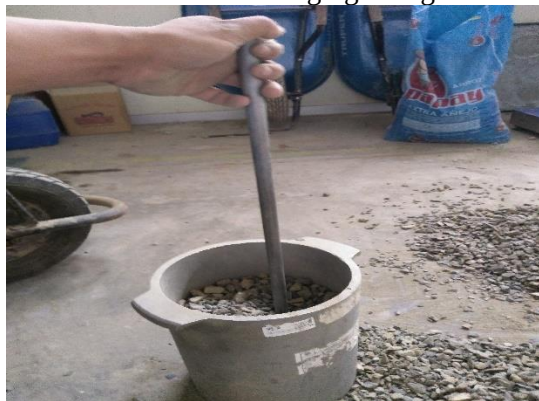
Varillado para determinar el peso unitario compactado
