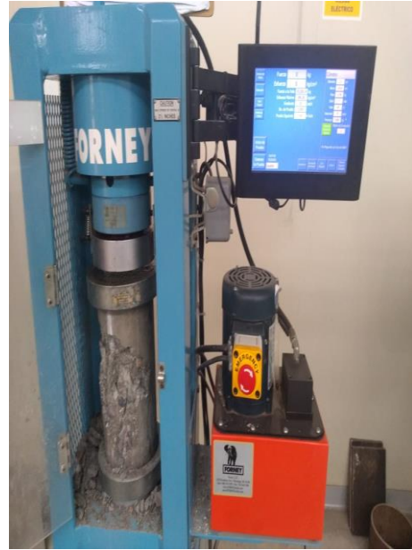
Rotura briqueta 7 días, AG tipo AR y resistencia 201.35 kg/cm 2
