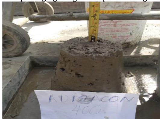
Slump de agregado grueso tipo A 300 kg/cm 2
