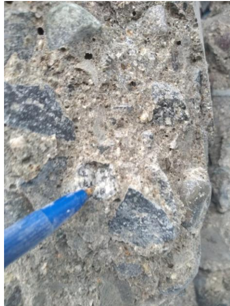
Rotura de AG tipo TC. Se muestra en roca fracturada con mayor presencia de cuarzo y paglioclasa
