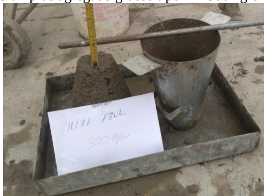
Slump de agregado grueso tipo A 300 kg/cm 2
