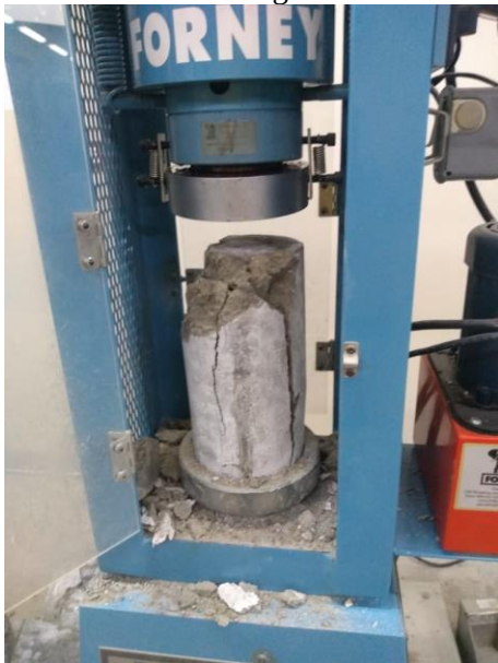
Rotura de briqueta 28 días, AG tipo TH falla tipo 3
