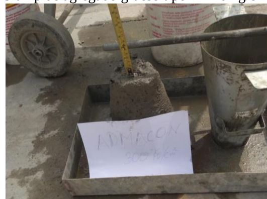
Slump de agregado grueso tipo TH 300 kg/cm 2
