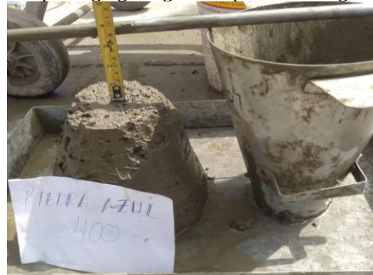
Slump de agregado grueso tipo A 400 kg/cm 2
