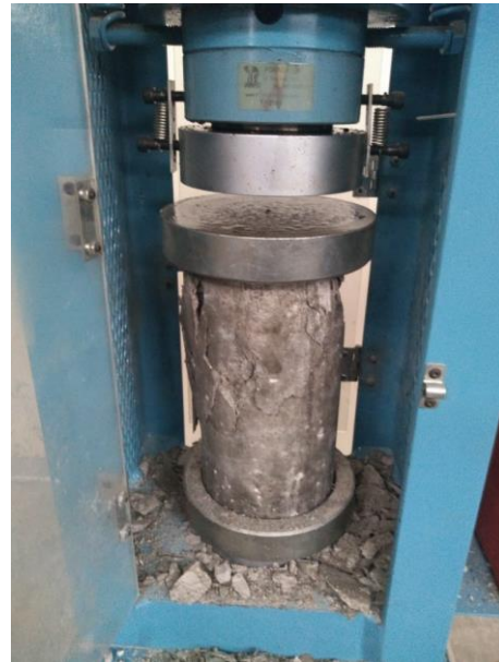
Rotura briqueta 7 días, AG tipo TH y resistencia 182.99 kg/cm 2
