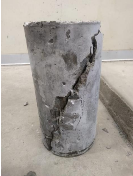
Rotura de briqueta 28 días, AG tipo TC resistencia 368.10 kg/cm 2
