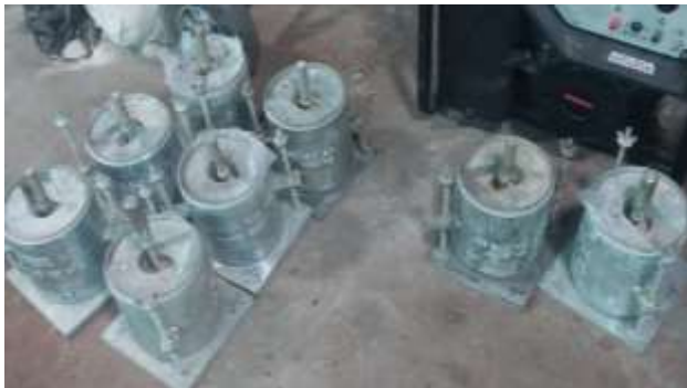
Ensayo de CBR
