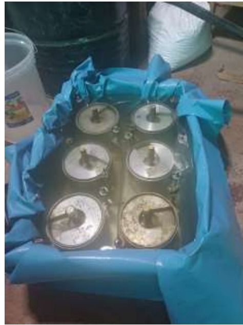
Ensayo de CBR, muestras sumergidas en agua
