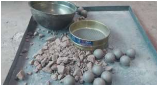
Equipo Utilizado para el Ensayo de abrasión en máquina de Los Ángeles
