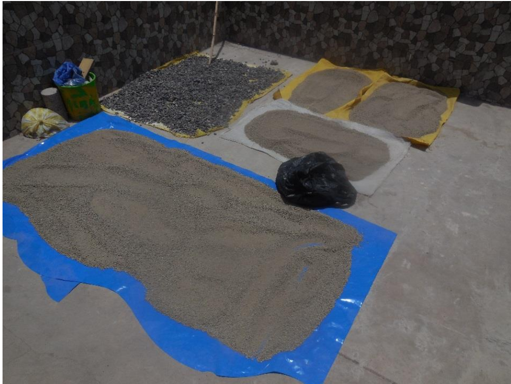
Ilustración 5. Secado de suelo arcilloso, para inicio de ensayos de laboratorio.
