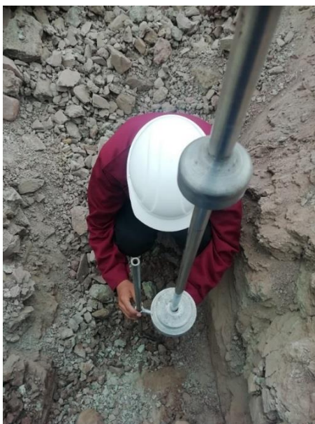
Figura 5. Ensayo con equipo Penetrometro Dinámico de Cono para el cálculo de CBR in situ (Fuente: Elaboración propia)
