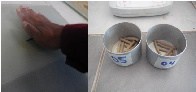
Figura 9 . Ensayo de límite plástico (Fuente: Elaboración propia)
