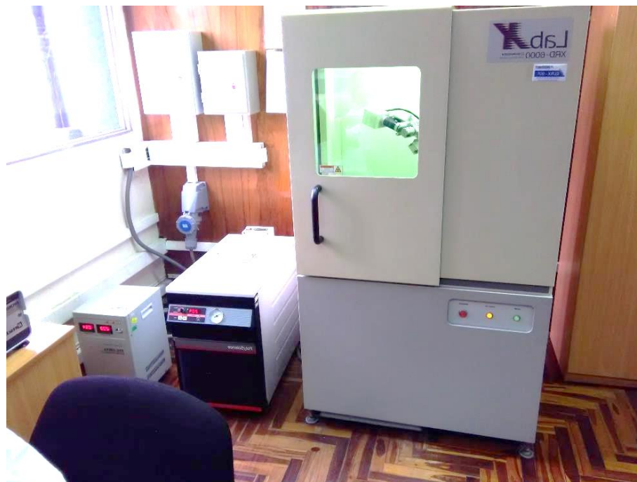
Figura 6. Equipo de laboratorio para ensayo de Difracción de Rayos X (Fuente: Elaboración propia)
