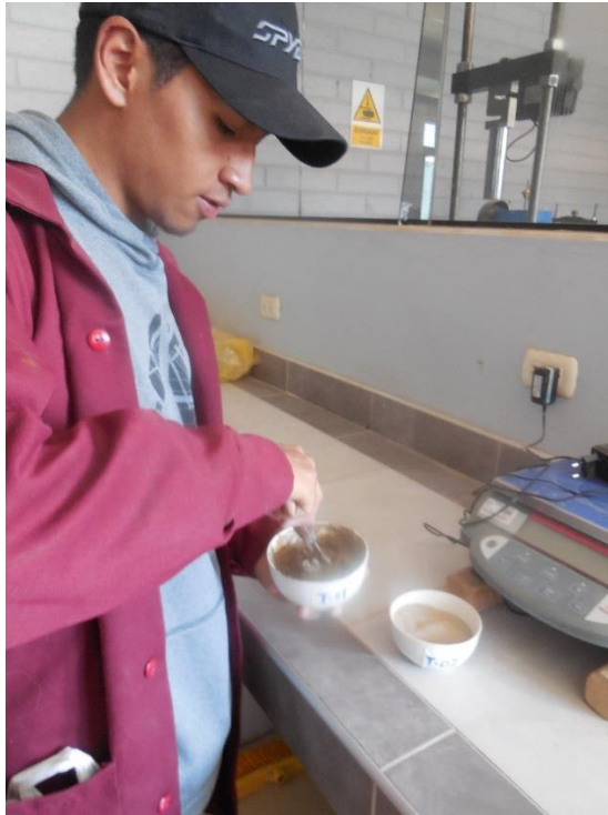
Ilustración 7. Preparación de muestra para ensayo de Límites de Atterberg.
