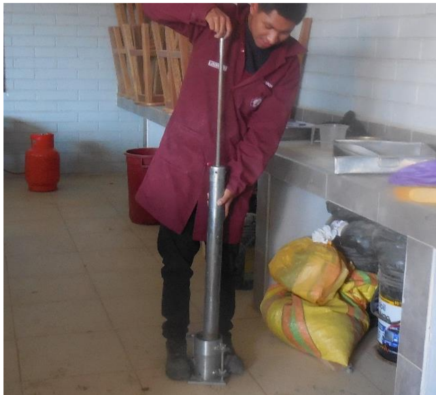
Ilustración 8. Ensayo de compactación Proctor Modificado.
