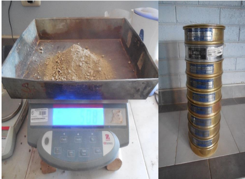
Figura 7. Ensayo de granulometría (Fuente: Elaboración propia)
