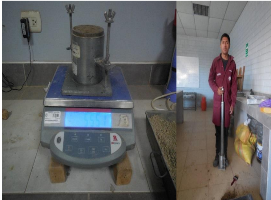
Figura 12. Ensayo de compactación Proctor Modificado (Fuente: Elaboración propia)
