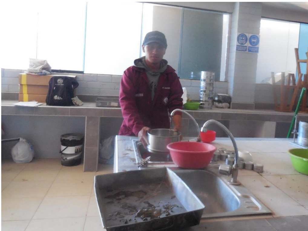
Ilustración 6. Ensayo de granulometría por lavado.
