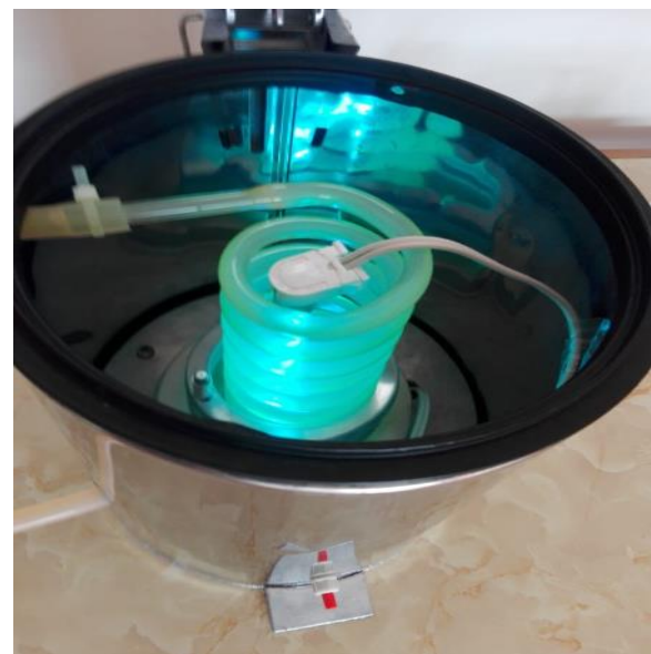
Figura 47. Prueba del correcto funcionamiento del reactor de tipo Bach.
