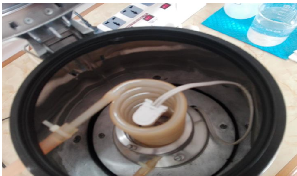
Figura 43. Reactor de tipo Bach con una radiación UV marca Philips (4w, 254nm), carcasa cilíndrica de metal, superficie reflectante de acero, tubo de boro silicato, volumen de 70 ml, un vaso precipitado de 1000 ml y caudal de 11.37 ml/s.
