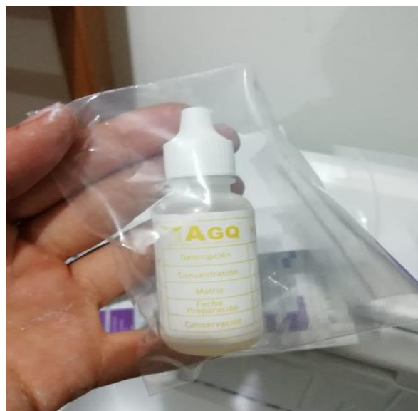
Figura 56. Ingreso del agua residual tratada a una botella esterilizada herméticamente cerrada.
