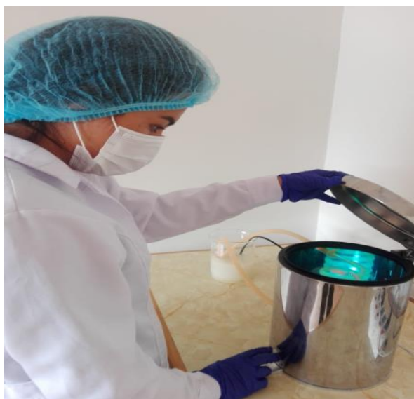
Figura 52. Después de 2 horas del tiempo de recirculación para el tratamiento del agua residual, se procederá a retirar el agua tratada.
