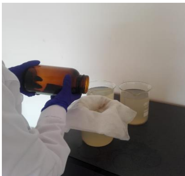
Figura 39. Se filtró las partículas suspendidas como materia orgánica del agua residual, para que ingrese al reactor de tipo Bach.
