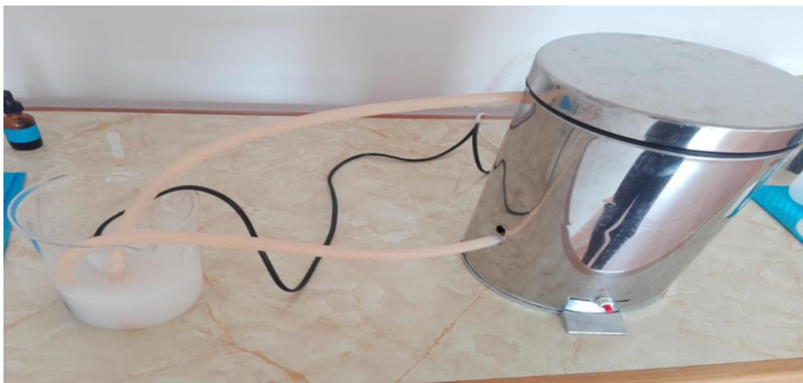
Figura 49. Tratamiento mediante proceso de oxidación avanzada (POA), donde se reproducirá especies oxidantes capaces de degradar compuestos de difícil degradación. Formando radical hidroxilo ( \text{OH}\cdot ), altamente reactivos que actúan como indicadores de la oxidación. El mayor auge son la fotólisis y fotocatalisis. Así inician las reacciones oxidantes en cadena, llevando a la mineralización completa de la materia orgánica.
