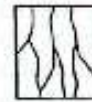
Tipo 3 Fisuras verticales sincronizadas a través de ambos extremos, conos no bien formados
