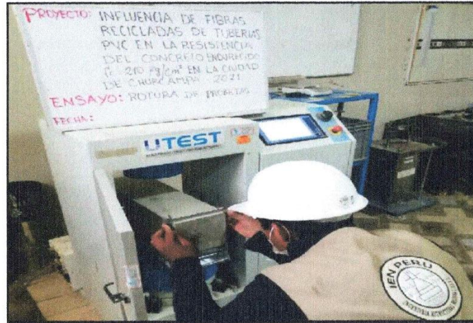
ROTURA DE PROBETA RESISTENCIA A LA FLEXION NTP 339.079
