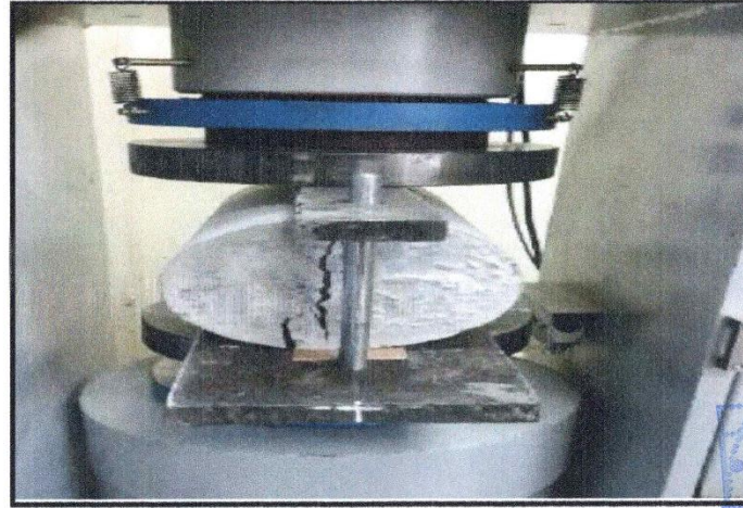
ROTURA DE PROBETA RESISTENCIA A LA FLEXION NTP 339.079
