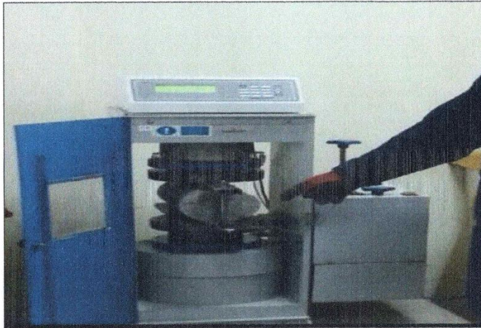
ROTURA DE PROBETA RESISTENCIA A LA FLEXION NTP 339.079
