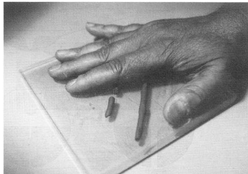
Imagen 11: Prueba del límite plástico. Fuente: PUCP, (2012)
