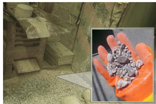
Fig. 3 Muestra de concreto reciclado triturada y clasificada por el tamiz N°4.
