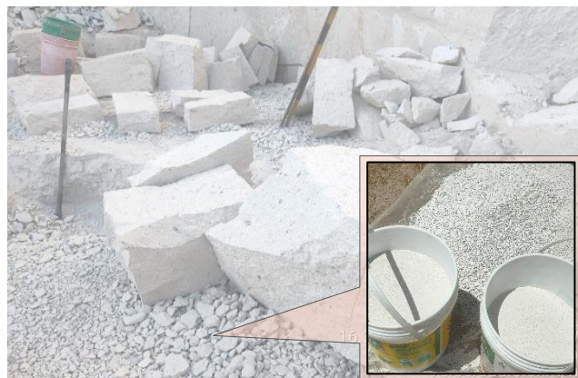
Fig. 4 Muestra recolectada, triturada y clasificada por el tamiz N° 100.
