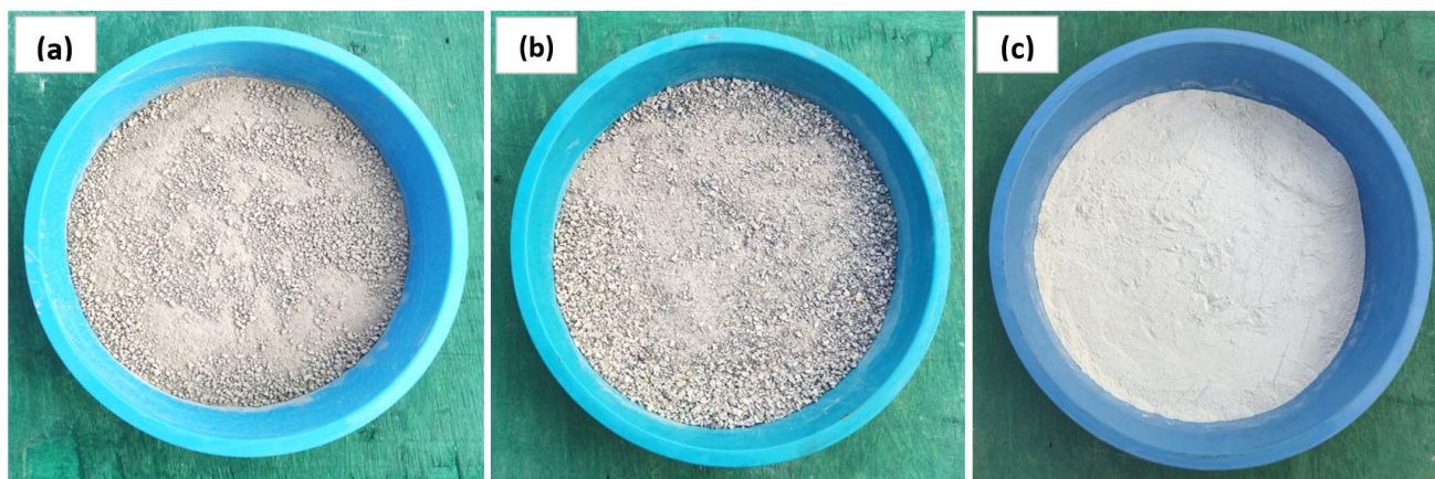
Fig. 13 (a) Muestra de suelo arcilla triturada, homogenizada y clasificada por el tamiz N° 4. (b) Muestra de concreto reciclado CR, triturada y clasificada por el tamiz N° 4. (c) Muestra de toba volcánica clasificada con el tamiz N° 100.
