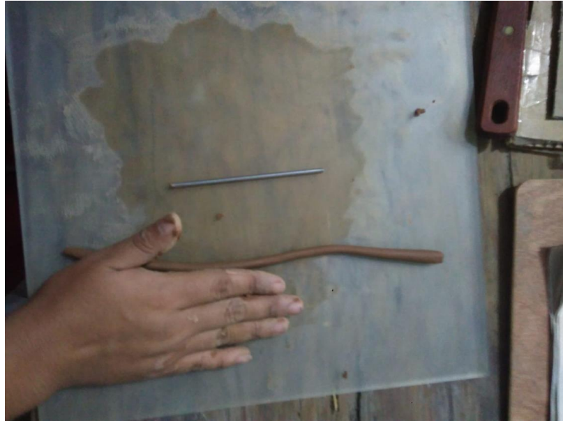
Figura 46. Ensayo limite plástico.
