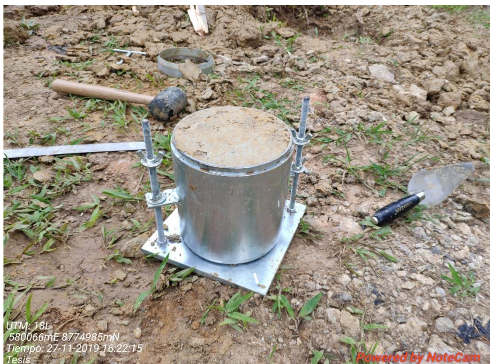
Figura 38. Perfilado de muestra inalterada y retiro del anillo de corte CBR.
