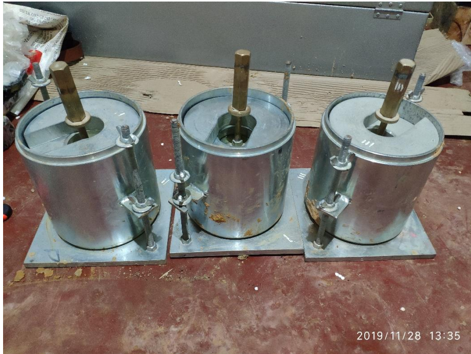
Figura 39. Muestras inalteradas con anillos de sobrecarga.
