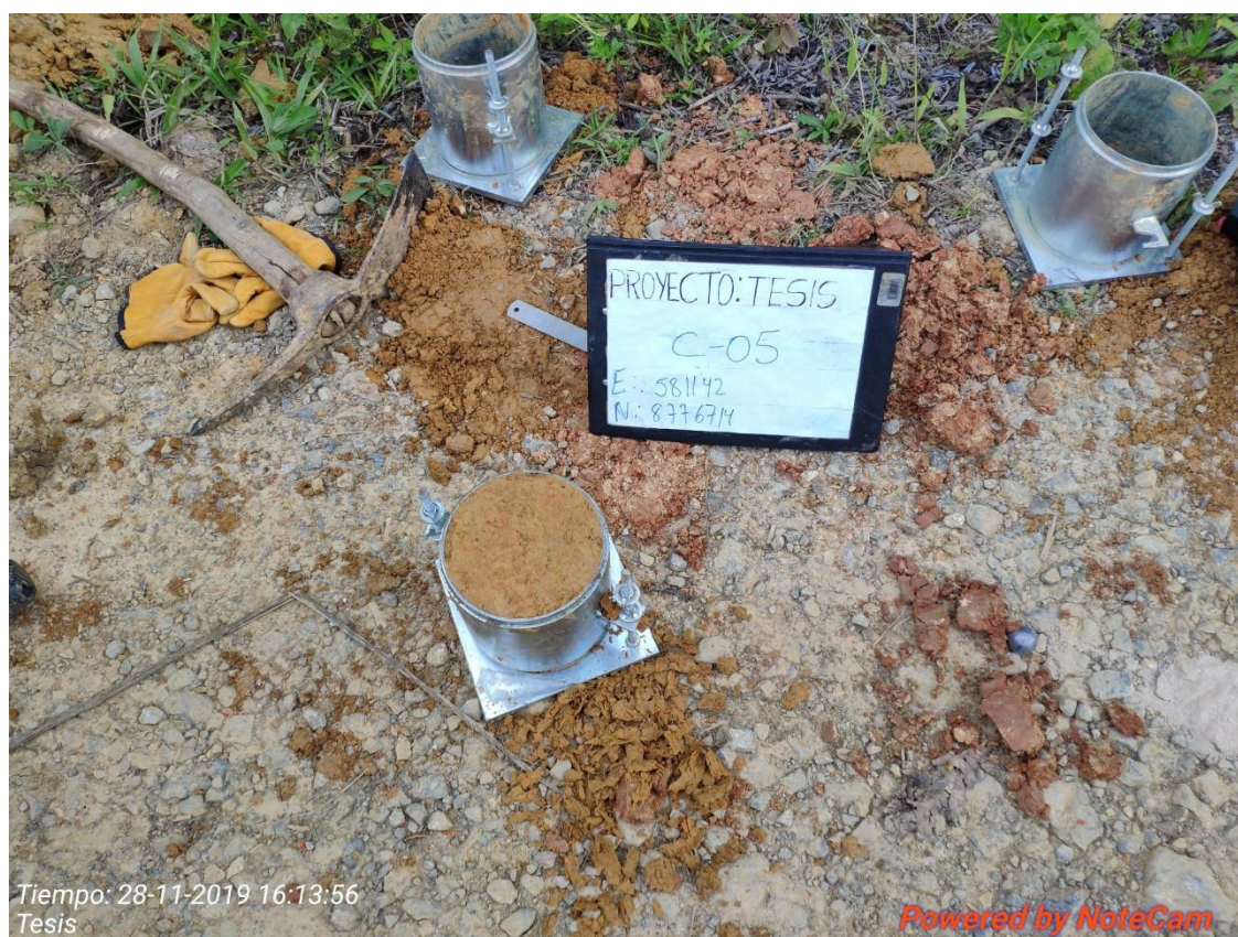
Fotografía 9. Extracción de muestra inalterada.
