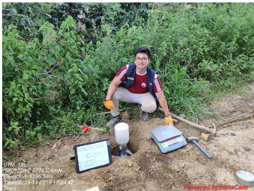
Fotografía 13. Densidad del suelo mediante cono de arena.
