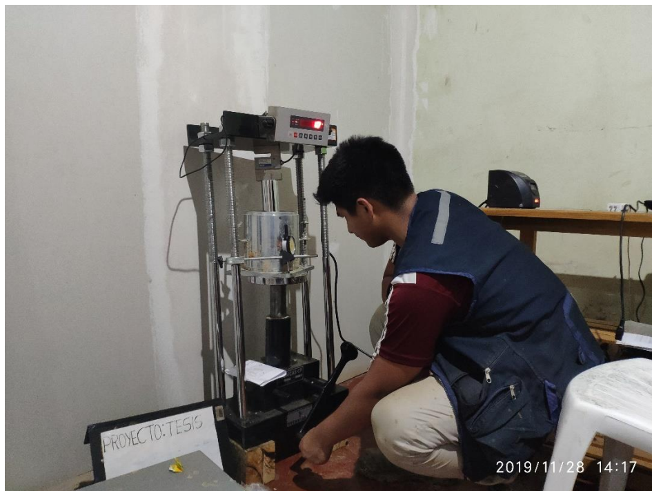
Figura 40. Ensayo de muestra inalterada en prensa CBR.
