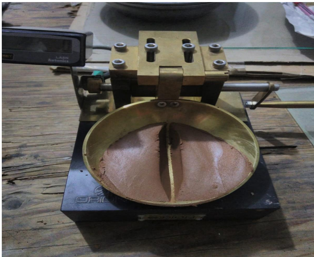
Fotografía 20. Ensayo de limite líquido para clasificación del suelo.
