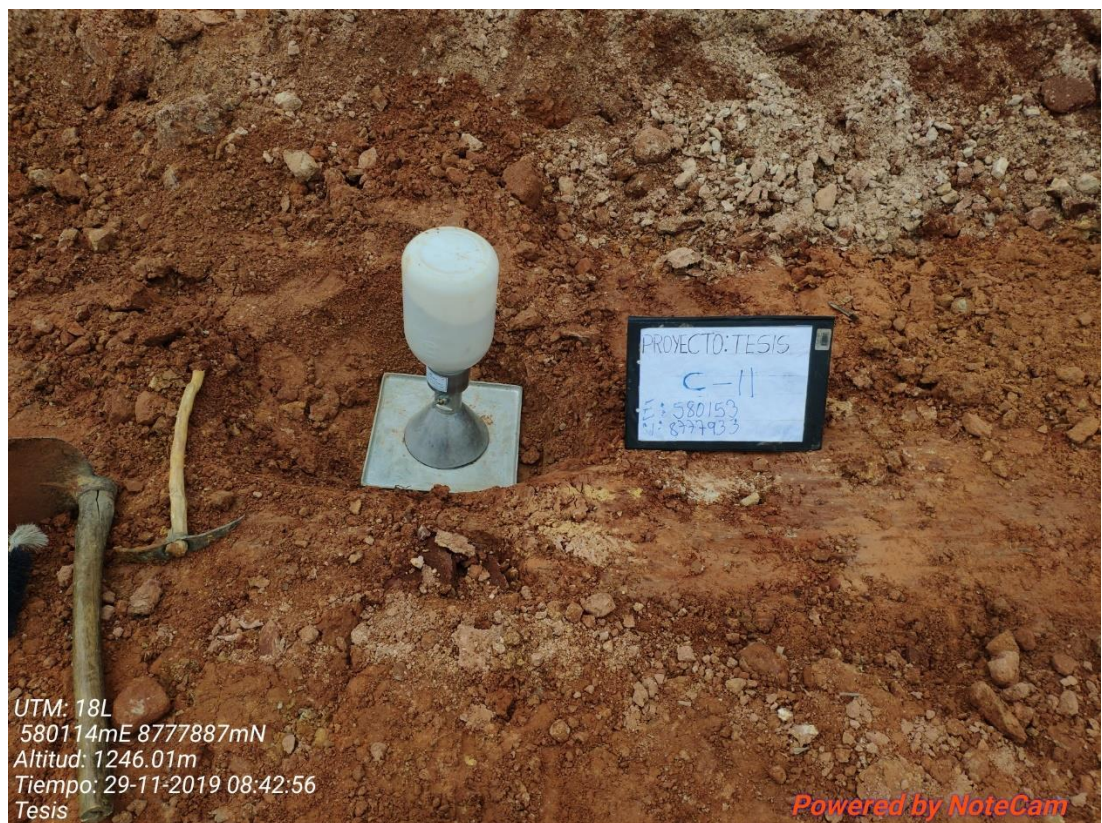
Fotografía 12. Densidad del suelo mediante cono de arena.
