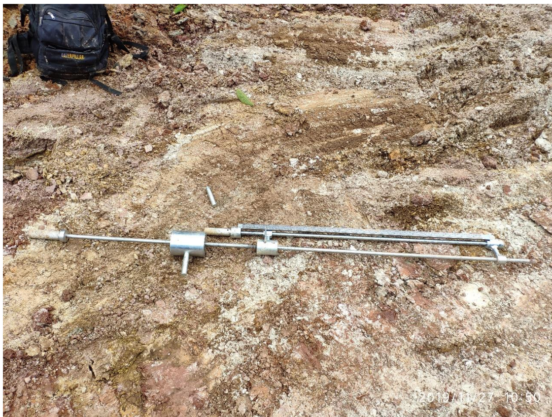
Fotografía 5. Derrumbe en el área de estudio y se comprobó el fácil transporte del equipo PDC en zonas inaccesibles.
