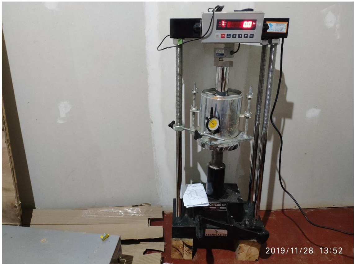
Fotografía 11. Ensayo de muestra inalterada en prensa CBR.
