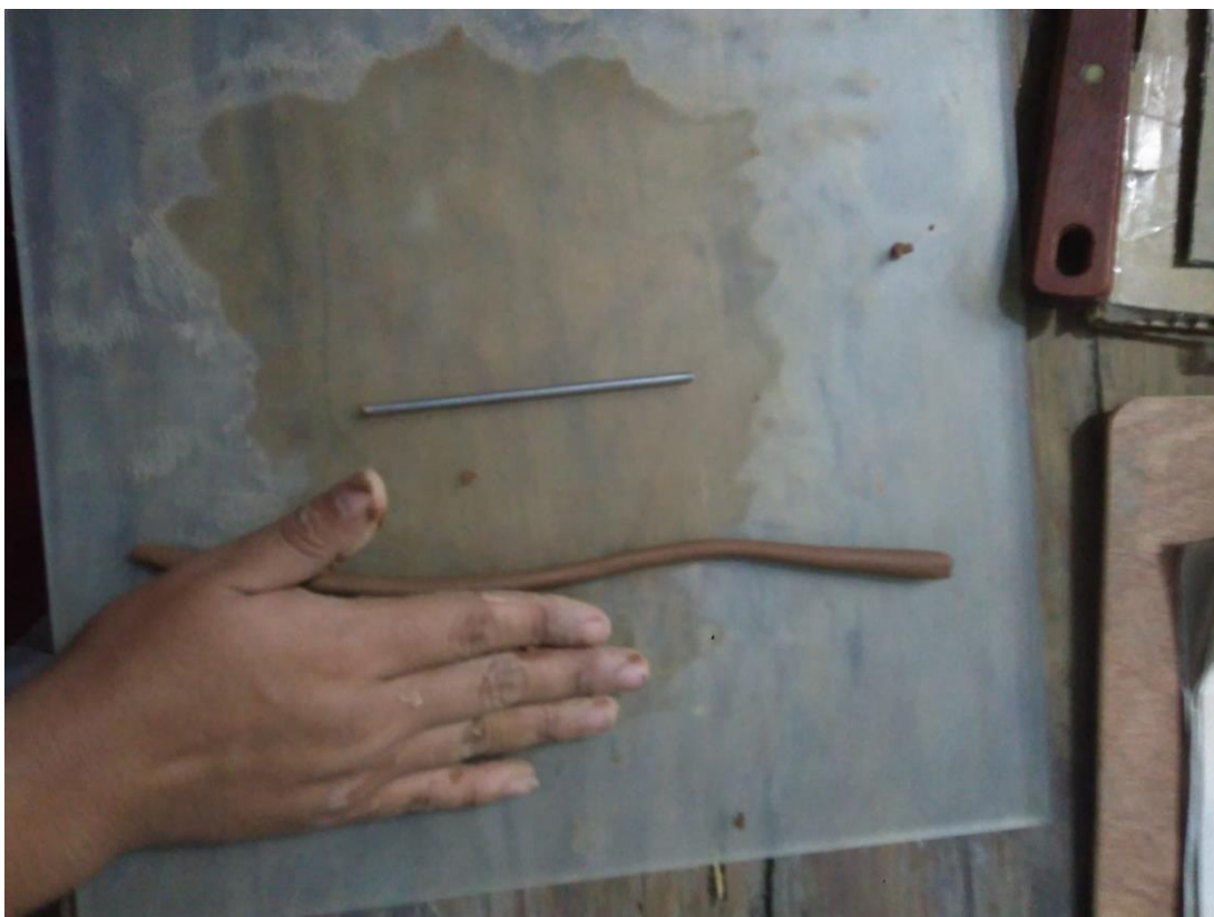
Fotografía 21. Ensayo de límite plástico.
