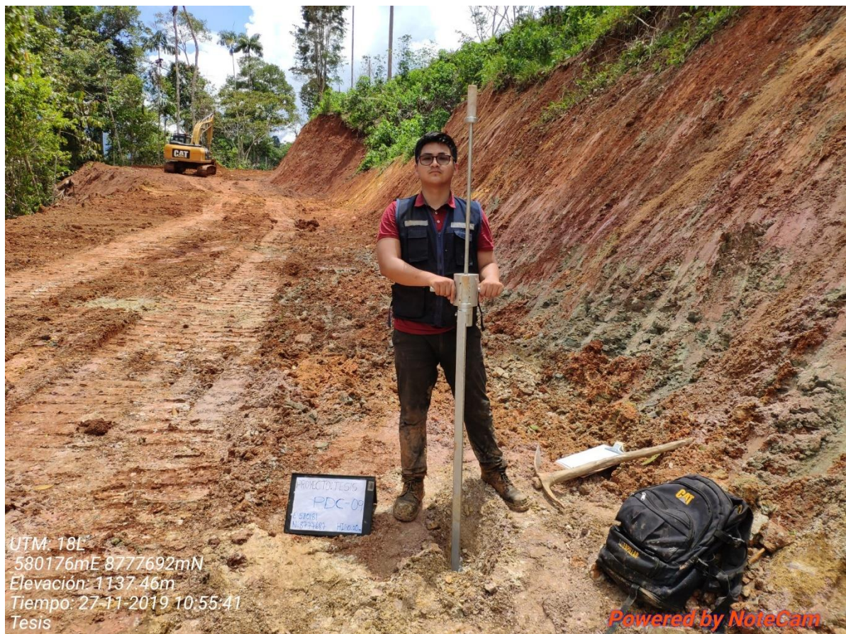
Fotografía 7. Ensayo de penetración dinámica de cono.
