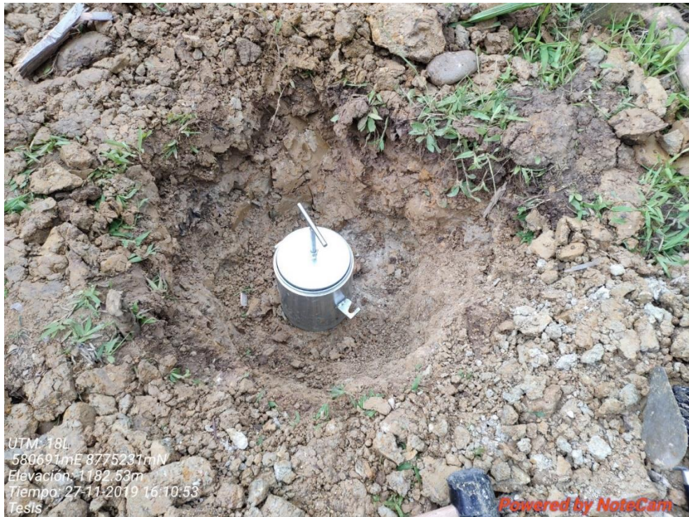
Figura 37. Disco espaciador para medir la altura del suelo a penetrar.
