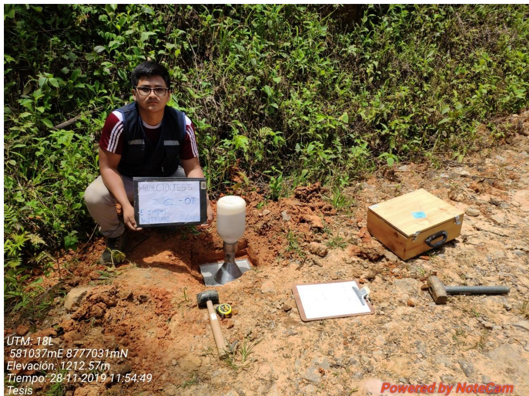
Fotografía 13. Densidad del suelo mediante cono de arena.
