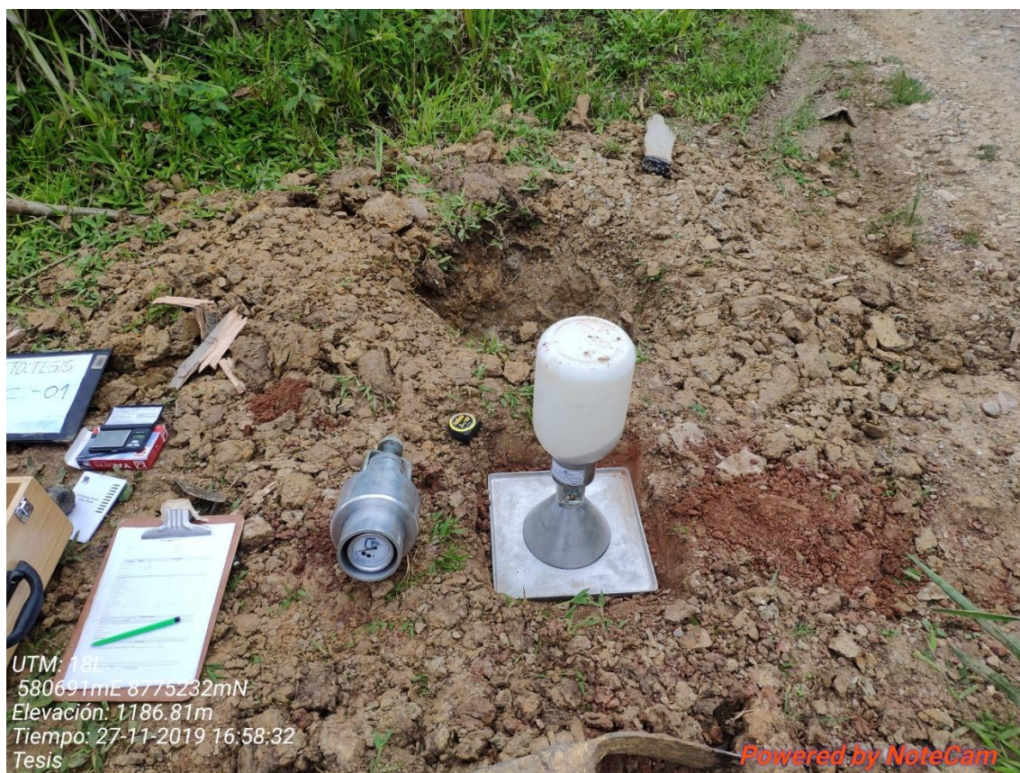
Fotografía 15. Contenido de humedad mediante carburo de calcio.
