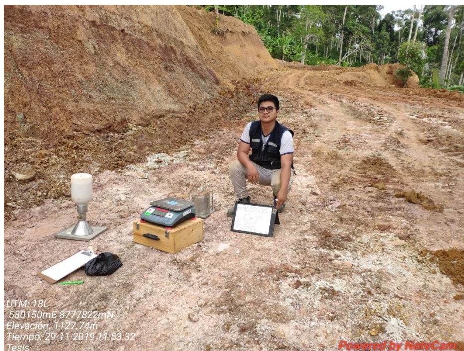
Figura 33. Ensayo de cono de Arena.
