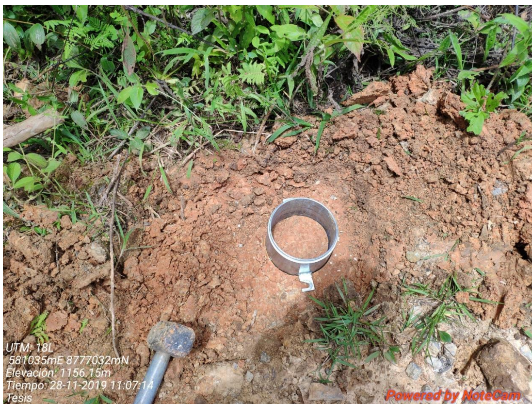
Fotografía 9. Extracción de muestra inalterada.
