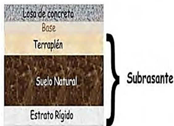
Figura 1: Estructura del pavimento mostrando subrasante.
