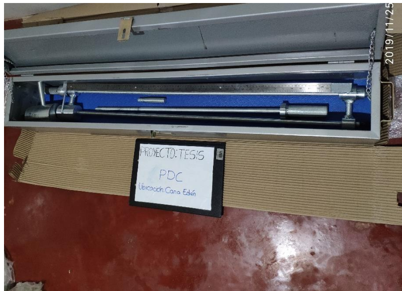
Figura 26: Penetrómetro dinámico de cono de 8kg.
