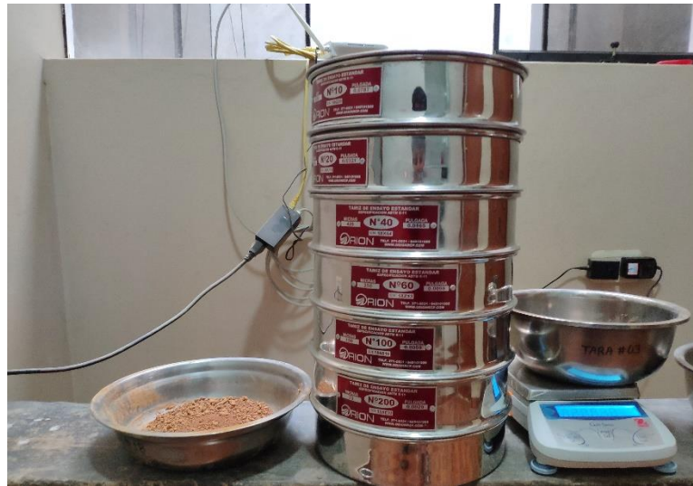
Figura 42. Juego de tamices empleados para clasificar las muestras de suelo.
