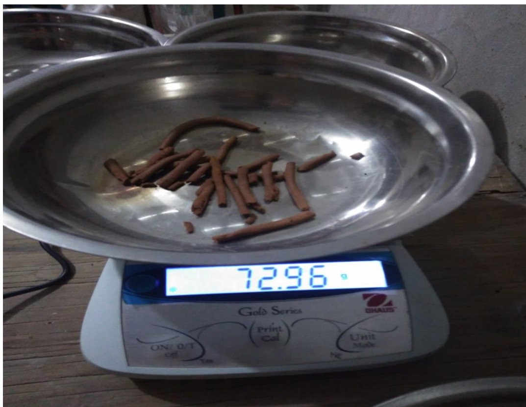
Fotografía 21. Ensayo de límite plástico.
