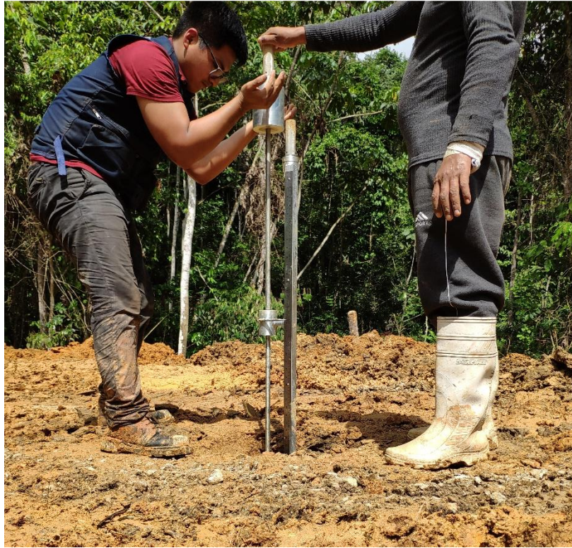
Figura 27: Operación básica del PDC.
