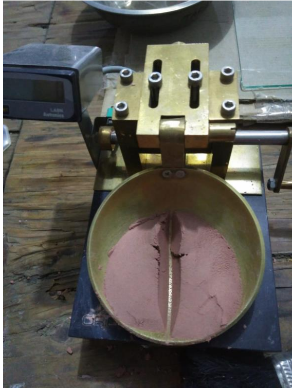
Figura 44. Muestra de suelo en la cuchara de Casagrande.
