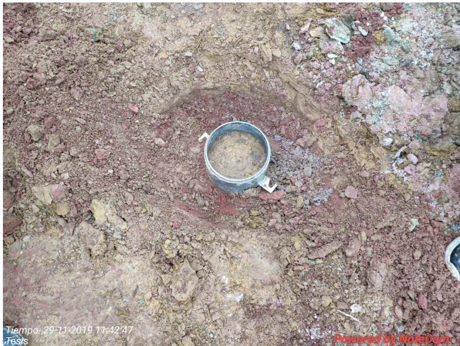
Figura 36. Anillo de corte y molde CBR introducido en el suelo.
