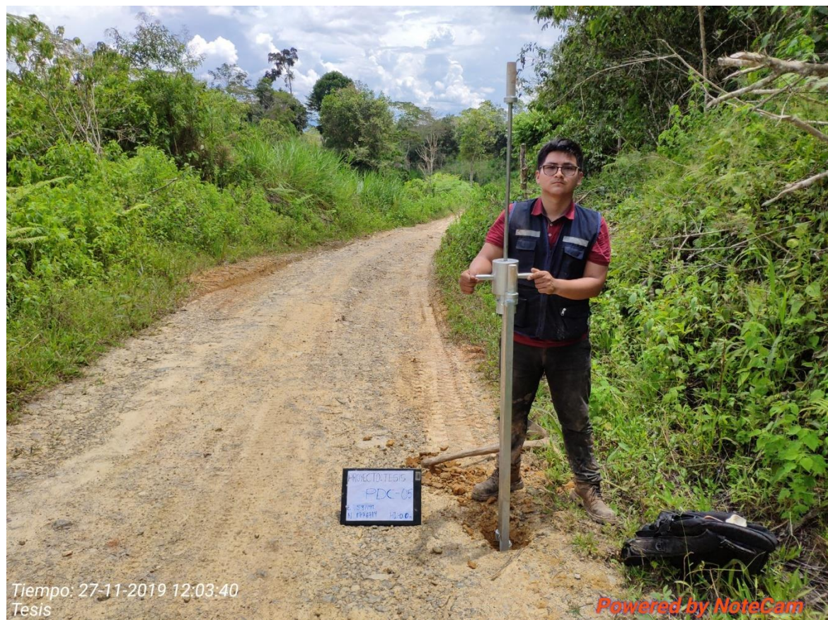
Fotografía 7. Ensayo de penetración dinámica de cono.
