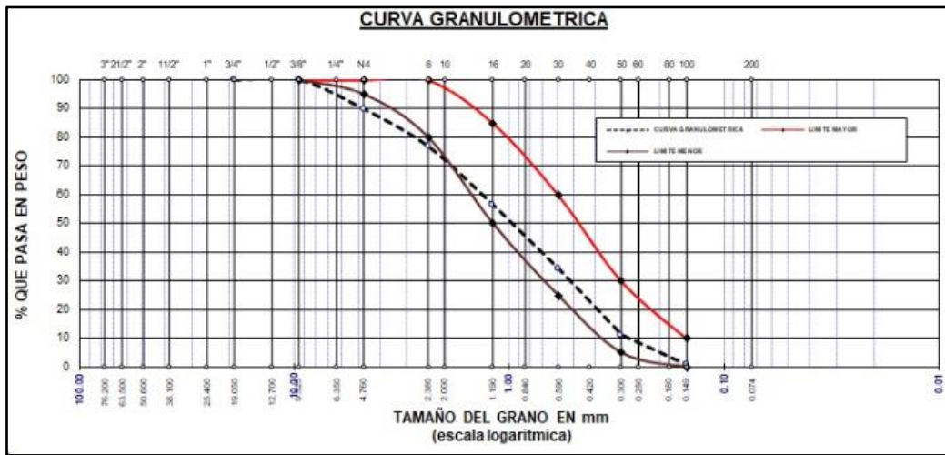
Figura5 Curva Granulométrica de agregado Fino
