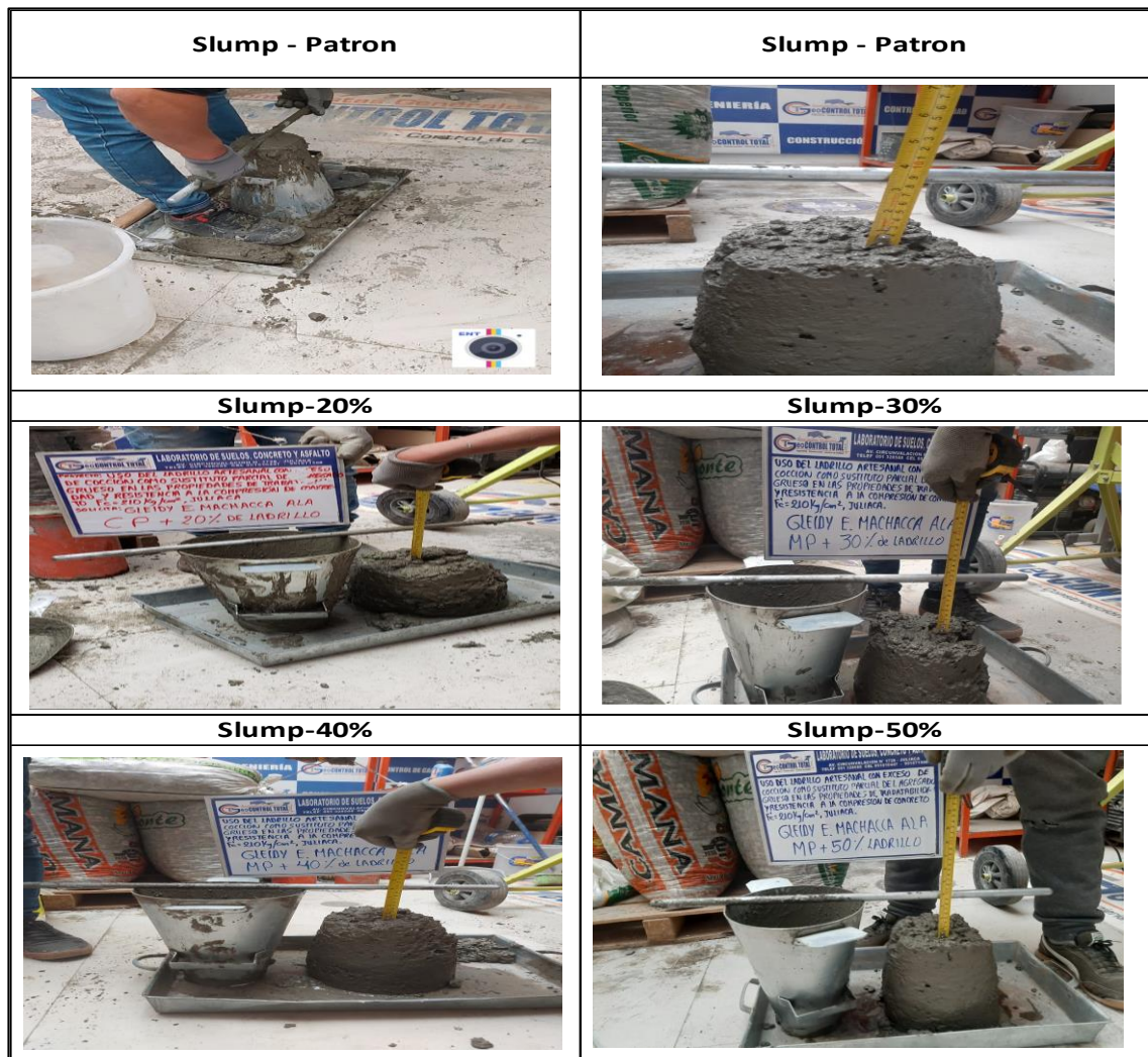
Figura15 forma de asentamiento en reemplazo de porcentajes 20%,30%,40%,50.
