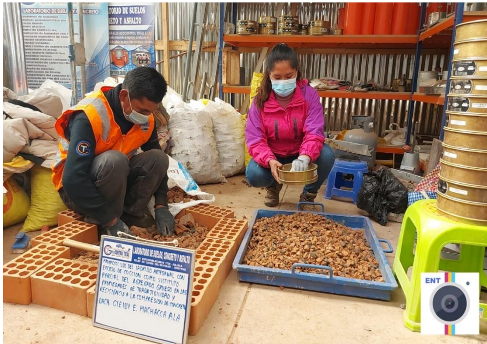
Fotografía 02. Se realiza el triturado manual del ladrillo recocido reciclado
