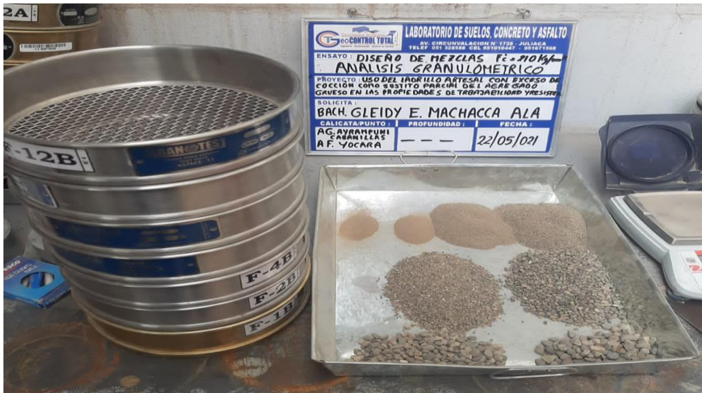
Figura6 Granulometría del Agregado Fino
