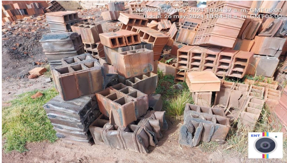
Figura4 Material de Cantera – Ladrillo con exceso de cocción Reciclado
