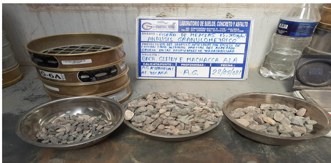
Figura10 Granulometría Agregado Grueso
