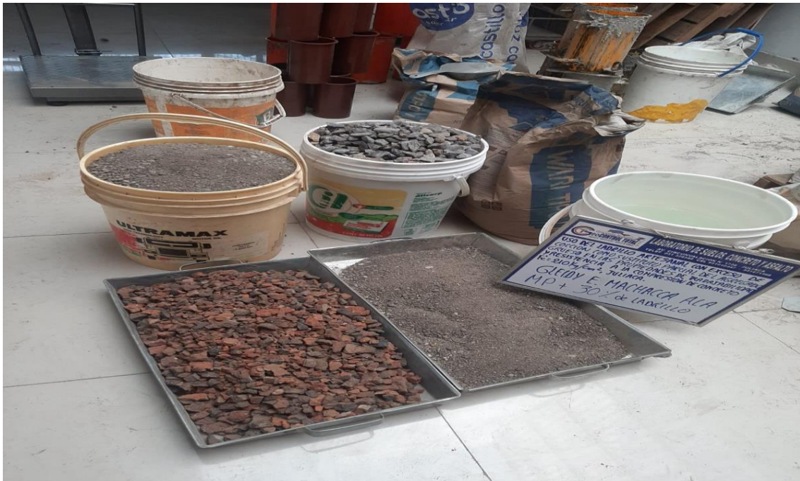
Figura13 Cantidad de materiales con porcentajes de ladrillo por m3 según Diseño de mezcla ACI
